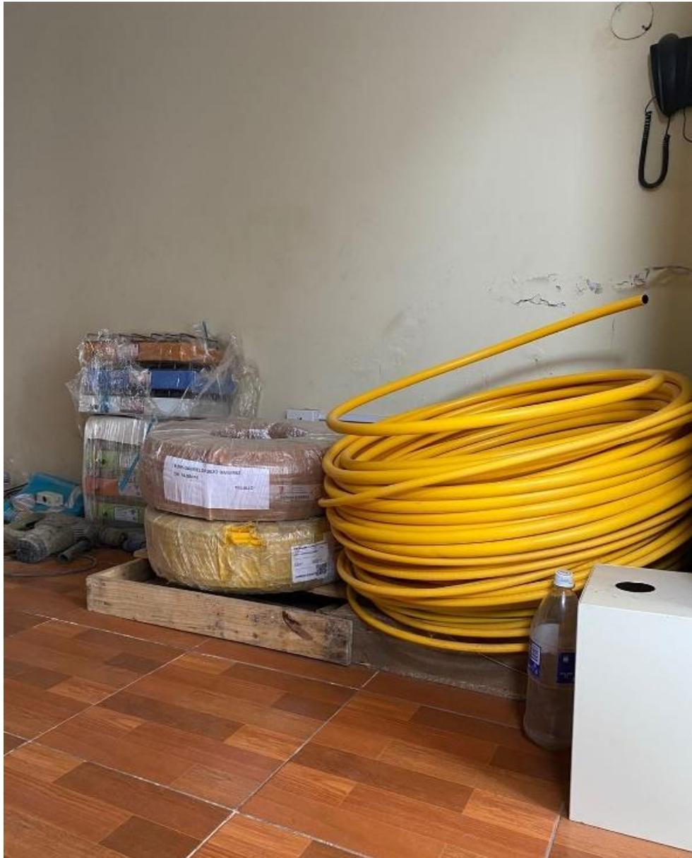
Para la nueva distribución de la Figura 11 se propone colocar dos pallets para la tubería PEALPE, debido a que los rollos apilados pueden manipularse de forma más sencilla con ayuda de una carretilla elevadora y no deben desplazarse rodando, según los criterios establecidos en la
