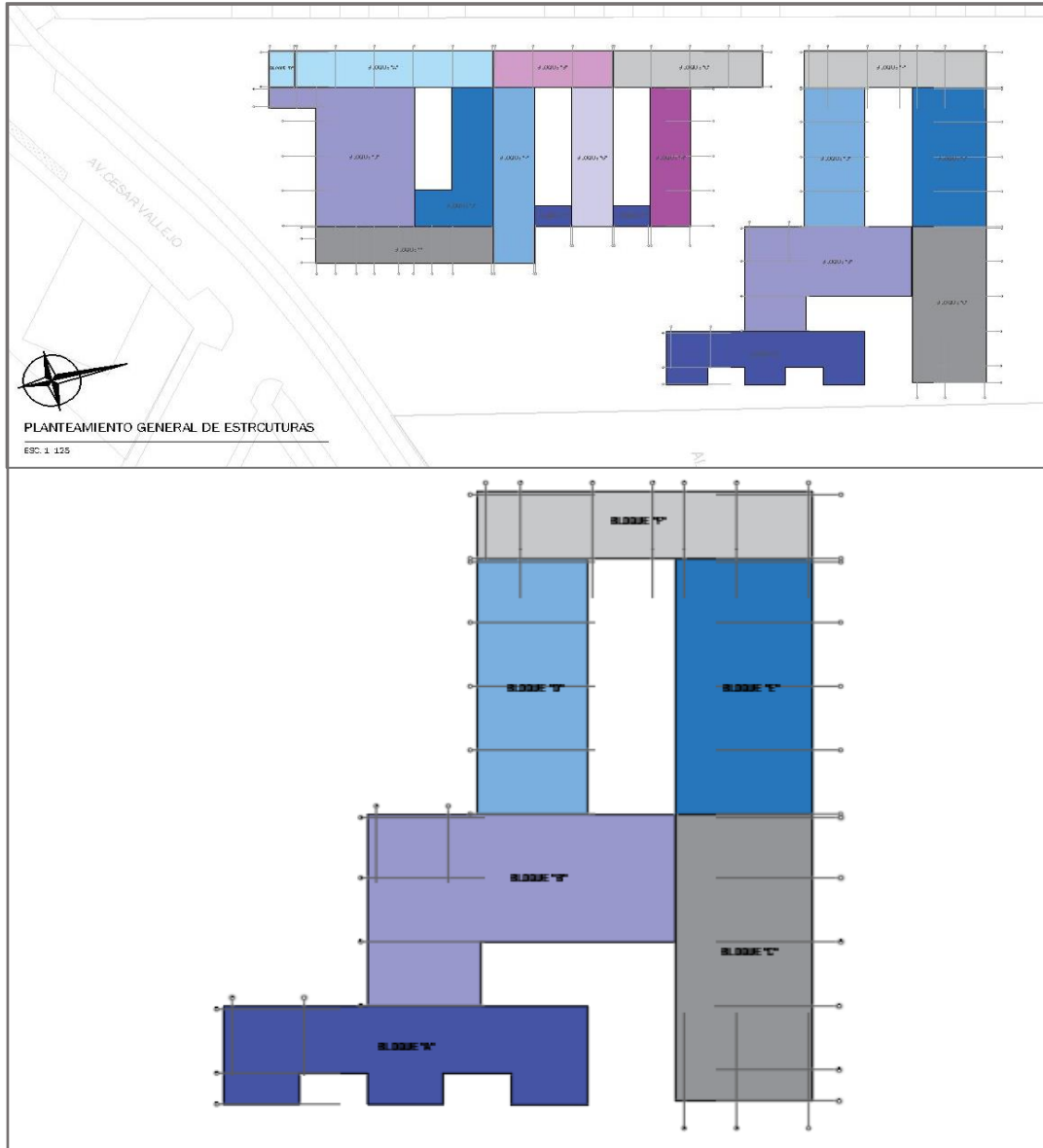
Figura N° 116: “Bloques estructurales y juntas de dilatación. Bloque 2: C.S.M.C.”
