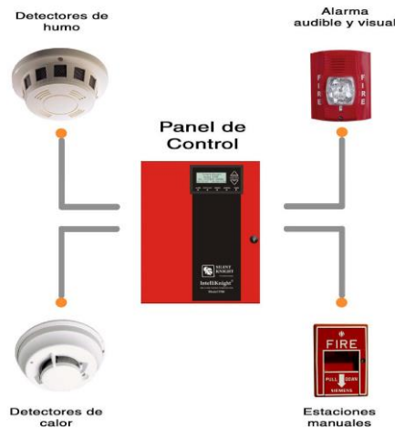
Figura N° 141: “Sistemas de alarma contra incendios”
