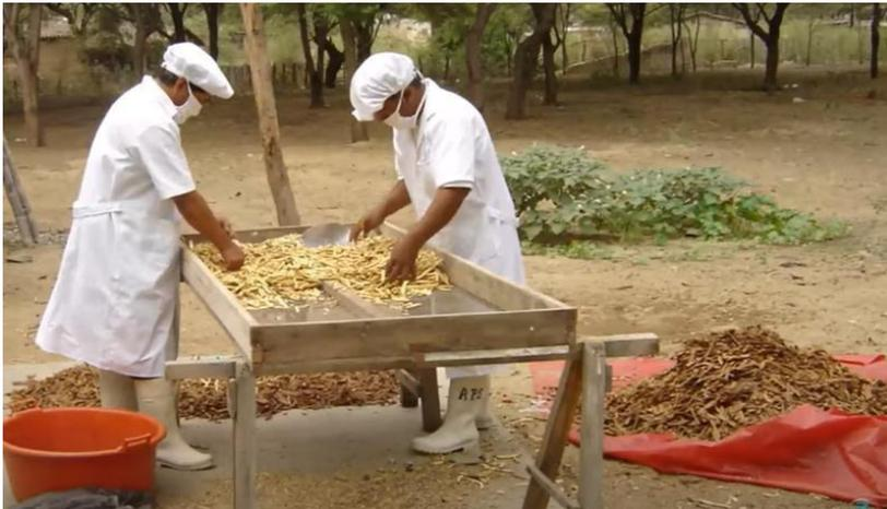
*Nota.* En la Figura 2, podemos apreciar en esta imagen como los operarios seleccionan la algarroba para dar comienzo a línea de producción; también podemos observar el bagazo de algarrobina cocida tirado en el plástico a temperatura ambiente hasta que se deshumedezca.
