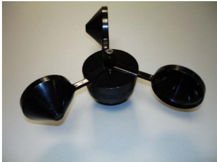
Figura N° 08: Anemómetro de Cazoletas
