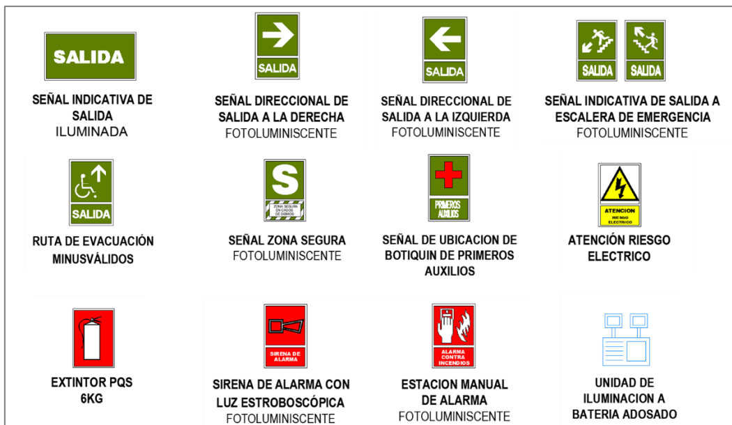
FIGURA N° 68: Tipos de señalización en el sector intervenido de la edificación
