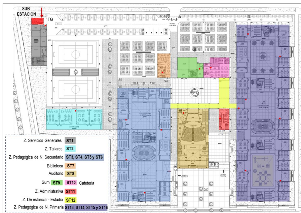
FIGURA N° 66: Distribución de Sub tableros eléctricos
