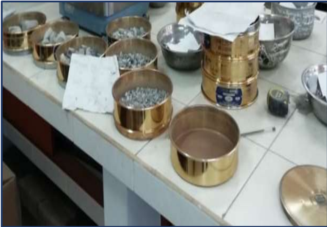
Anexo 9: Tamizado de las muestras recolectadas en campo.
