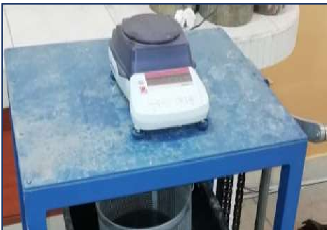
Anexo 11: Ensayo para el peso específico de material de fondo.
