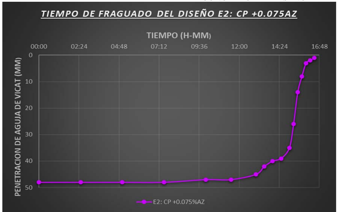
FIGURA 7: CURVA TIEMPO VS PENETRACIÓN DE AGUJA DE VICAT PARA DETERMINAR EL TIEMPO DE FRAGUADO INICIAL Y FINAL DE LA PASTA DE CONCRETO DEL DISEÑO E2
