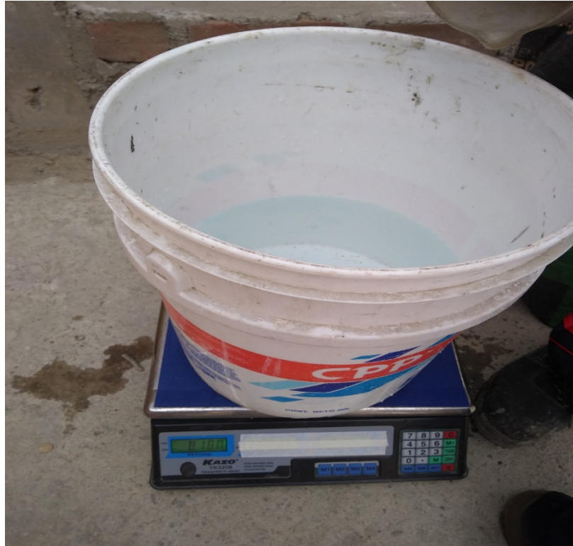
fotografía 27. Peso del agua de mezcla. Fuente propia.
