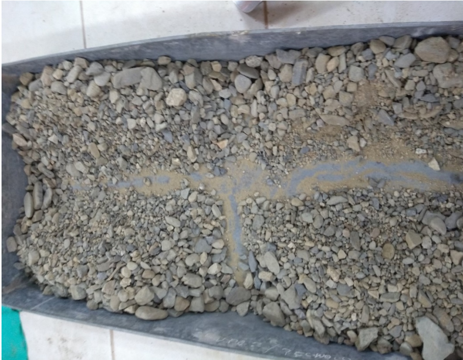
Fotografía 1. Cuarteo del agregado grueso Fuente propia.
