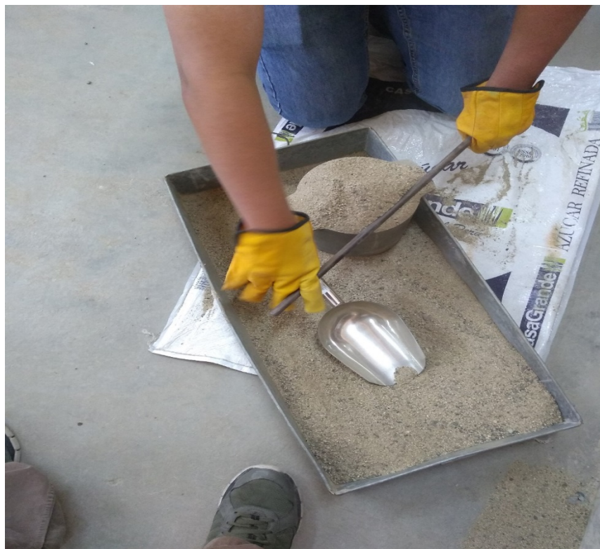
Fotografía 16. Enrasado del agregado fino en el recipiente. Fuente propia.
