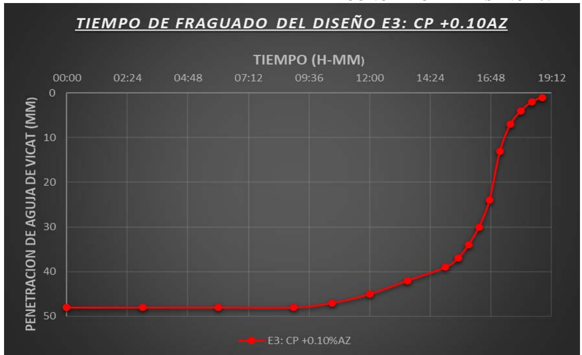
FIGURA 8: CURVA TIEMPO VS PENETRACIÓN DE AGUJA DE VICAT PARA DETERMINAR EL TIEMPO DE FRAGUADO INICIAL Y FINAL DE LA PASTA DE CONCRETO DEL DISEÑO E3.
