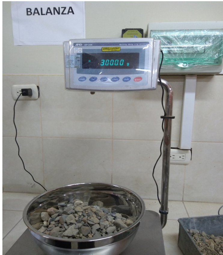
Fotografía 3. Peso del agregado grueso Fuente propia.
