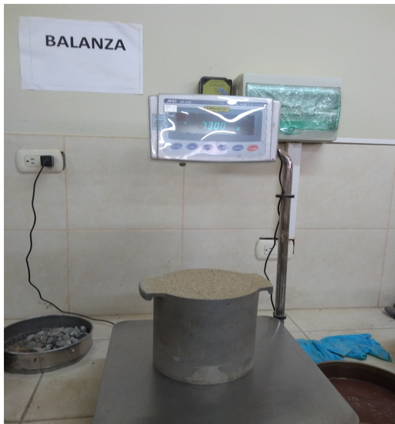
Fotografía 18. Peso del agregado fino más el recipiente. Fuente propia.
