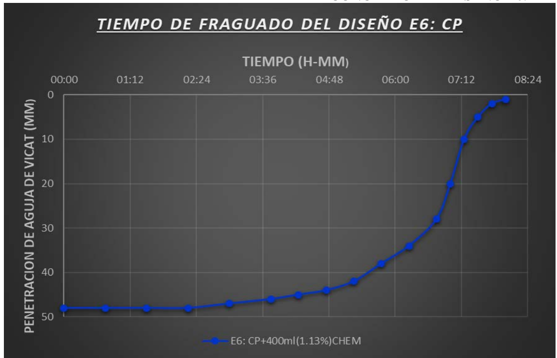
FIGURA 11: : CURVA TIEMPO VS PENETRACIÓN DE AGUJA DE VICAT PARA DETERMINAR EL TIEMPO DE FRAGUADO INICIAL Y FINAL DE LA PASTA DE CONCRETO DEL DISEÑO E6.
