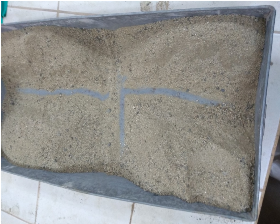
Fotografía 2. Cuarteo del agregado fino. Fuente propia.
