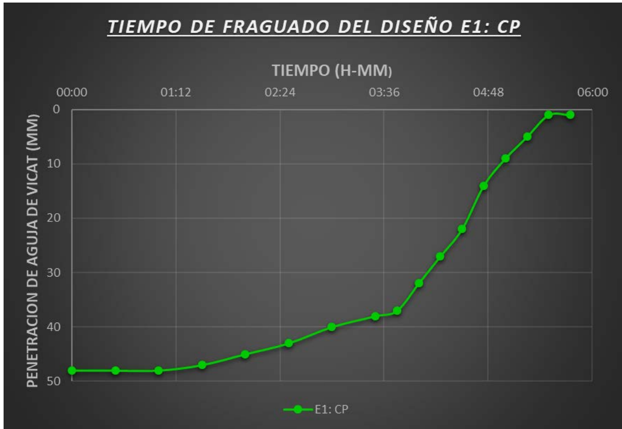
FIGURA 6: CURVA TIEMPO VS PENETRACIÓN DE AGUJA DE VICAT PARA DETERMINAR EL TIEMPO DE FRAGUADO INICIAL Y FINAL DE LA PASTA DE CONCRETO DEL DISEÑO E1
