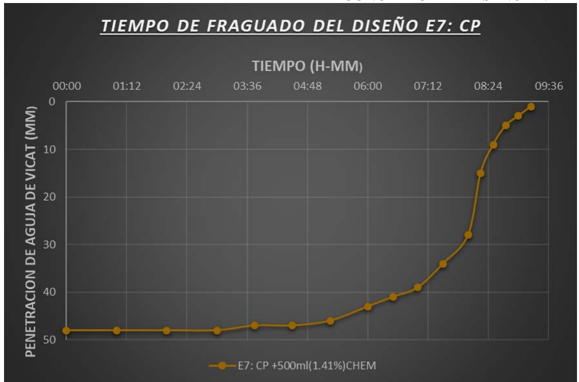
FIGURA 12: CURVA TIEMPO VS PENETRACIÓN DE AGUJA DE VICAT PARA DETERMINAR EL TIEMPO DE FRAGUADO INICIAL Y FINAL DE LA PASTA DE CONCRETO DEL DISEÑO E7.
