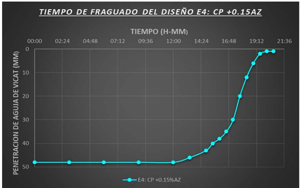
FIGURA 9: CURVA TIEMPO VS PENETRACIÓN DE AGUJA DE VICAT PARA DETERMINAR EL TIEMPO DE FRAGUADO INICIAL Y FINAL DE LA PASTA DE CONCRETO DEL DISEÑO E4.
