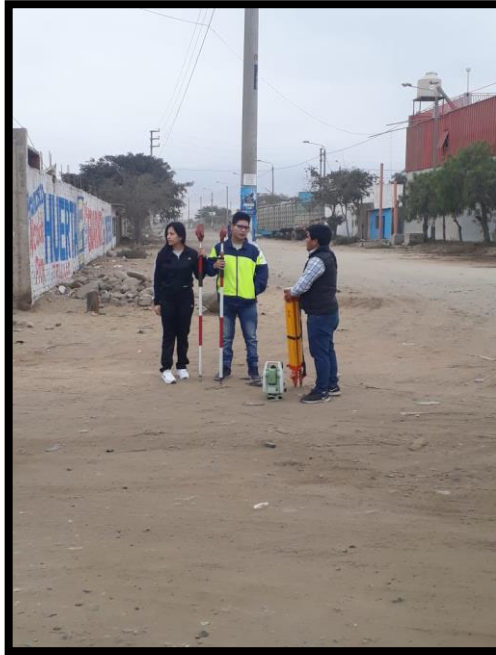
Ubicación de Estación Total para el inicio del levantamiento topográfico.
