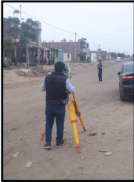
Se da lectura a medir puntos para el seccionamiento de la vía.
