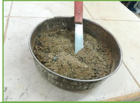
Preparación de la muestra después de haber sido metida al horno  $110\text{ }^{\circ}\text{C} \pm 5$ .
