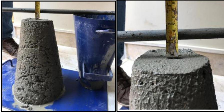
**Figura N°8:** “Slump” de la mezcla sin incorporación de concha de abanico.
