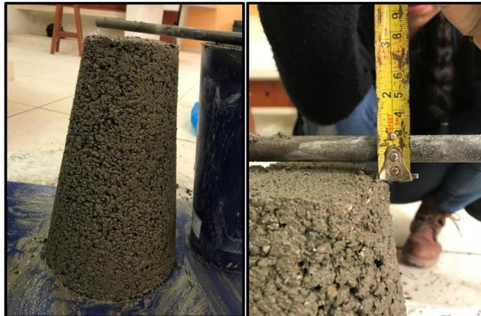
**Figura N°9:** “Slump” de la mezcla con incorporación de concha de abanico.
