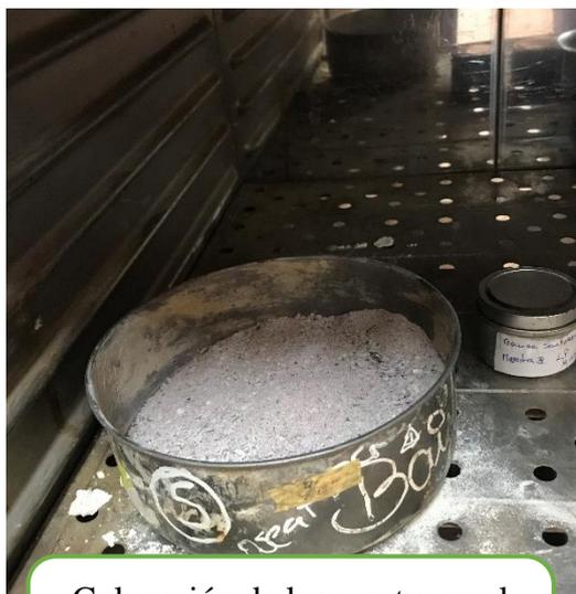
Colocación de la muestra en el horno  $110\text{ }^{\circ}\text{C} \pm 5$ .
