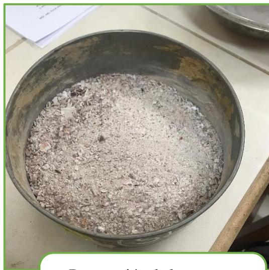
Preparación de la muestra para el tamizado.
