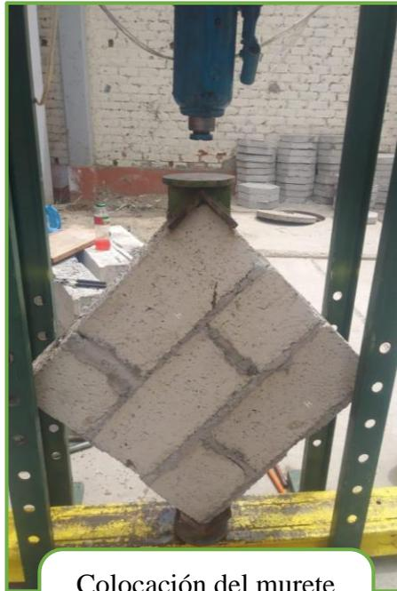
Colocación del murete en la máquina.
