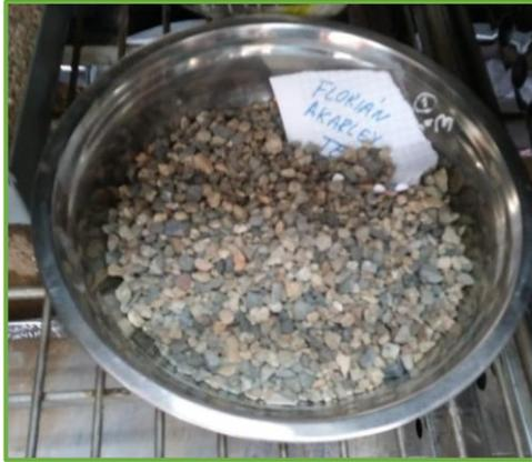
Meter la muestra al horno a 110°C a 24 hrs.
