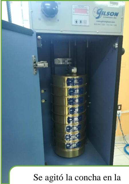
Se agitó la concha en la máquina tamizadora mecánica.
