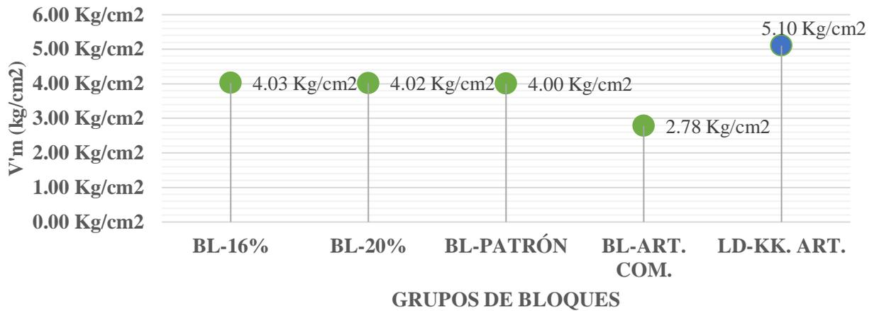
**Figura N° 36:** Ensayo de Compresión diagonal de muretes.
