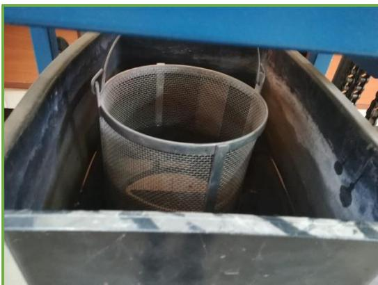
Poner la muestra en la balanza sumergida
