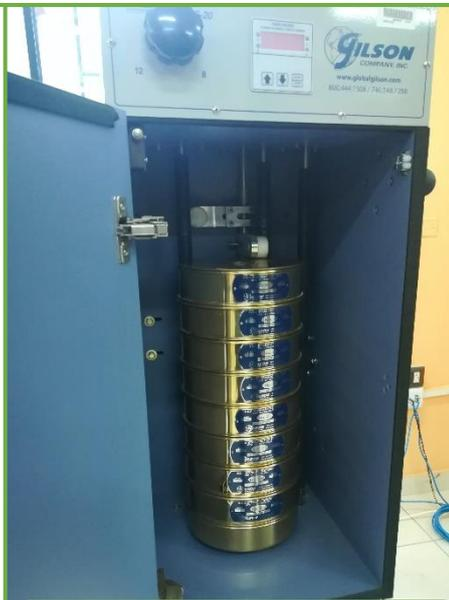
Agitado de la arena en la máquina tamizadora mecánica.
