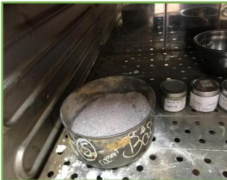
Meter la muestra al horno 110°C a 24 hrs.
