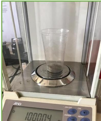
Pesaje de los componentes de la mezcla de concreto.
