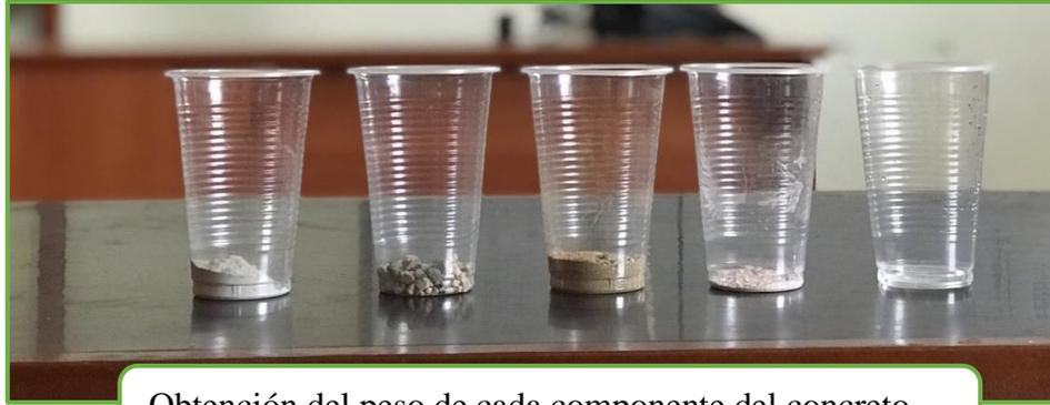
Obtención del peso de cada componente del concreto
