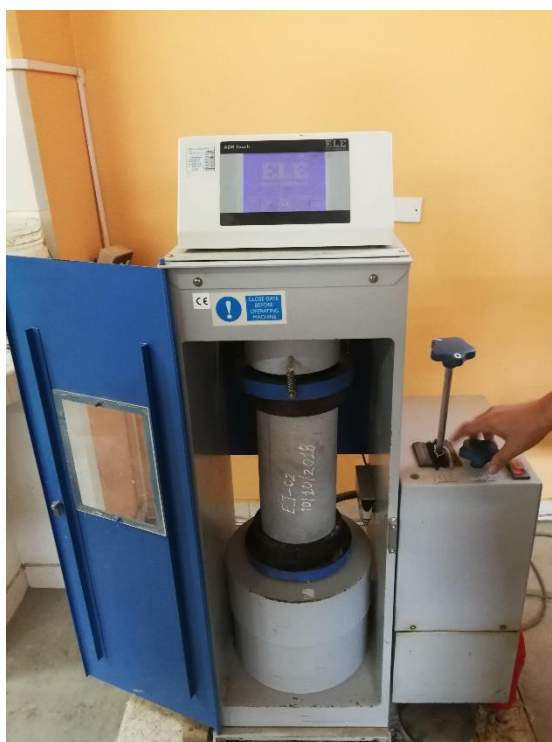
Foto N° 33: Ensayo de compresión EJ-2
