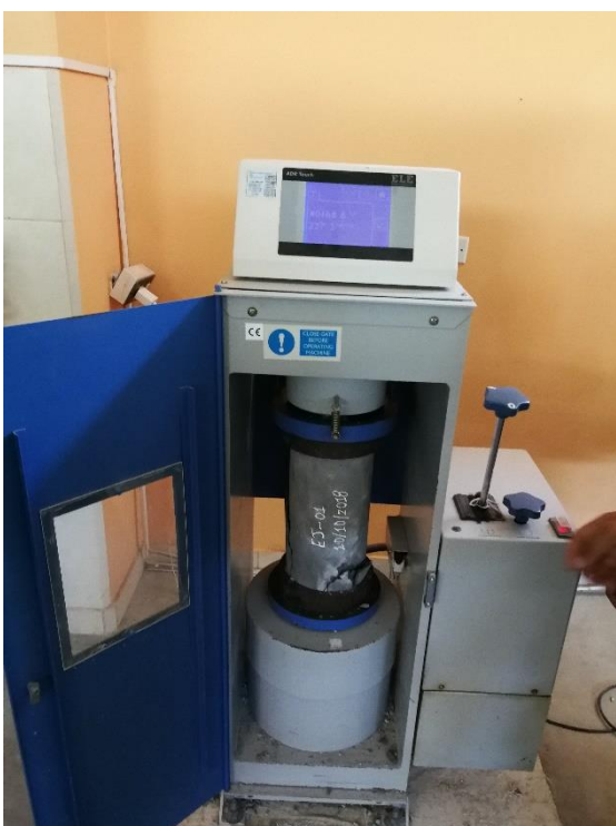
Foto N° 32: Ensayo de compresión EJ-1
