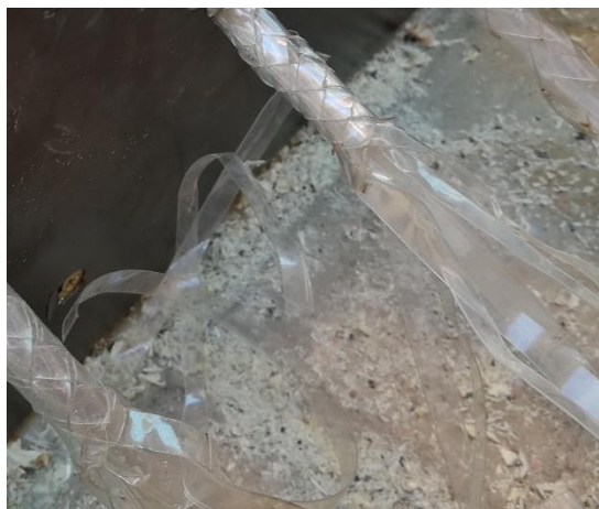
Foto N° 23: Fibra PET (soga trenzada de 6 hebras)
