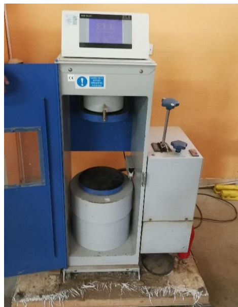
Foto N° 6: Máquina ensayo a compresión
