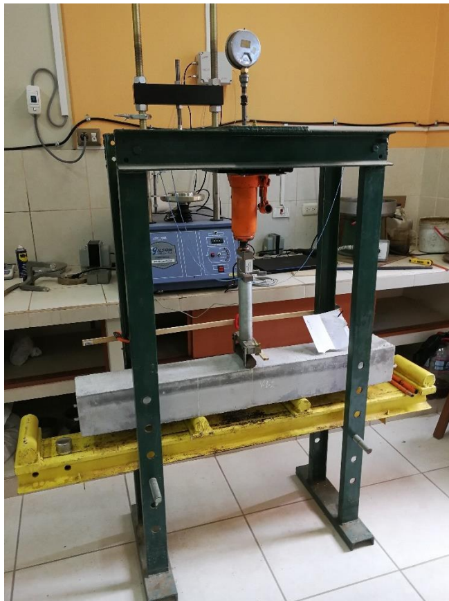
Foto N° 16: Colocación de bloque aplicador de carga
