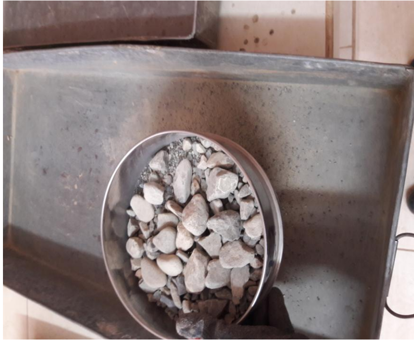
Imagen N°48: Material que pasa la malla n°12 y lo retenido se pesa
