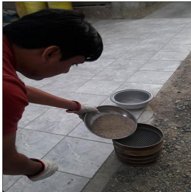
Imagen N° 17 Ensayo granulométrico al agregado fino
