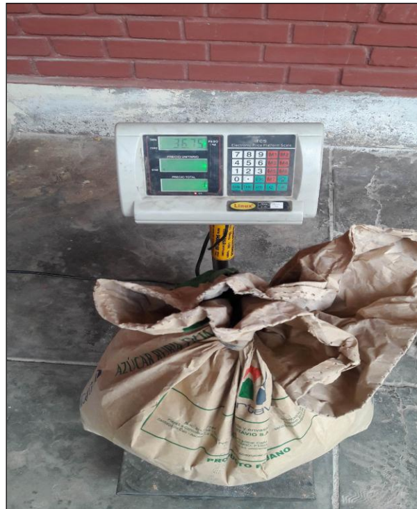
Imagen N° 6: Pesado de cáscara de huevo pulverizada
