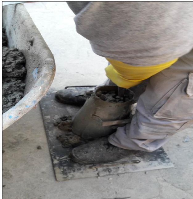
Imagen N°23: Apisonado de mezcla por capas en cono de Abrams
