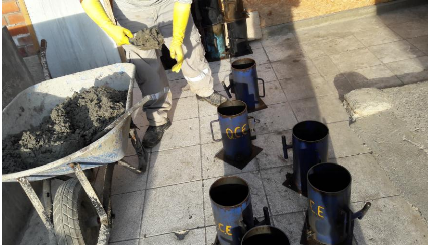
Imagen N°31: Moldes cilíndricos de 15x30 cm.
