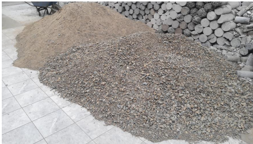
Imagen N° 14 Agregado grueso y agregado fino
