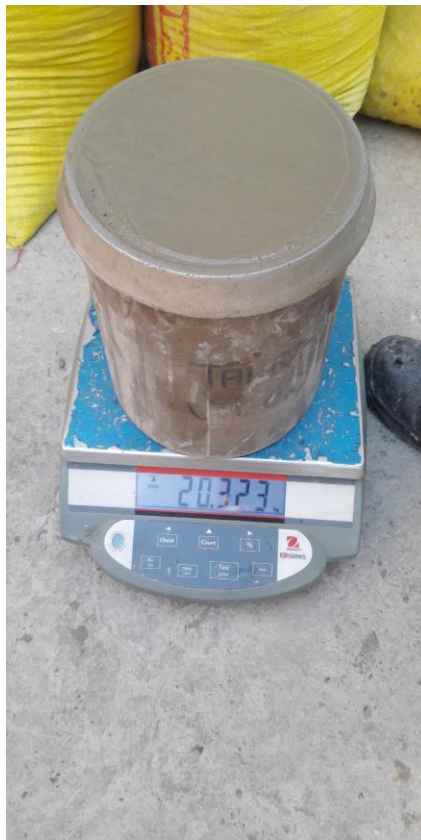
Imagen N°30: Pesaje final del recipiente con mezcla y toma de datos
