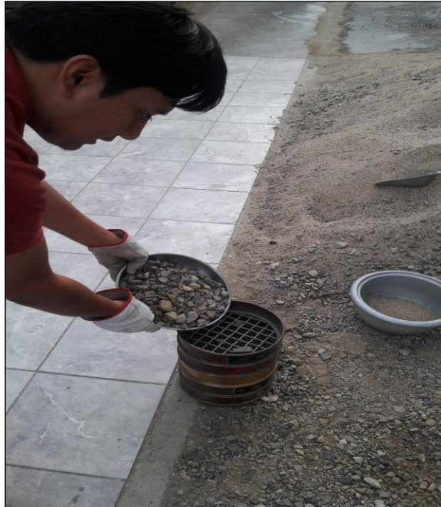
Imagen N° 16 Ensayo granulométrico al agregado grueso
