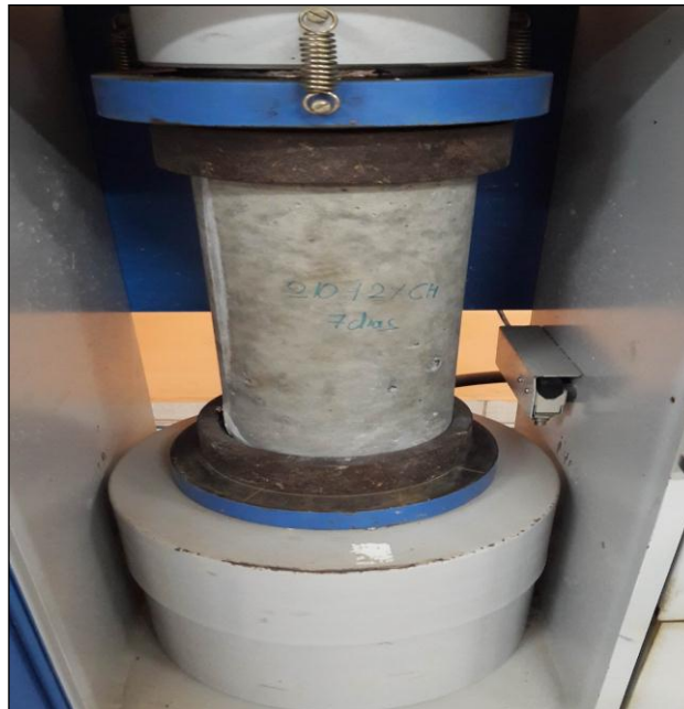
Imagen N°36: Colocación de espécimen en máquina compresora
