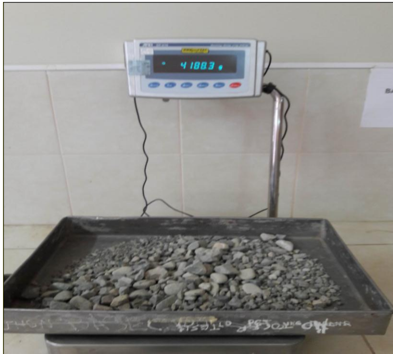
Imagen N°49: Pesaje final de la muestra después del ensayo
