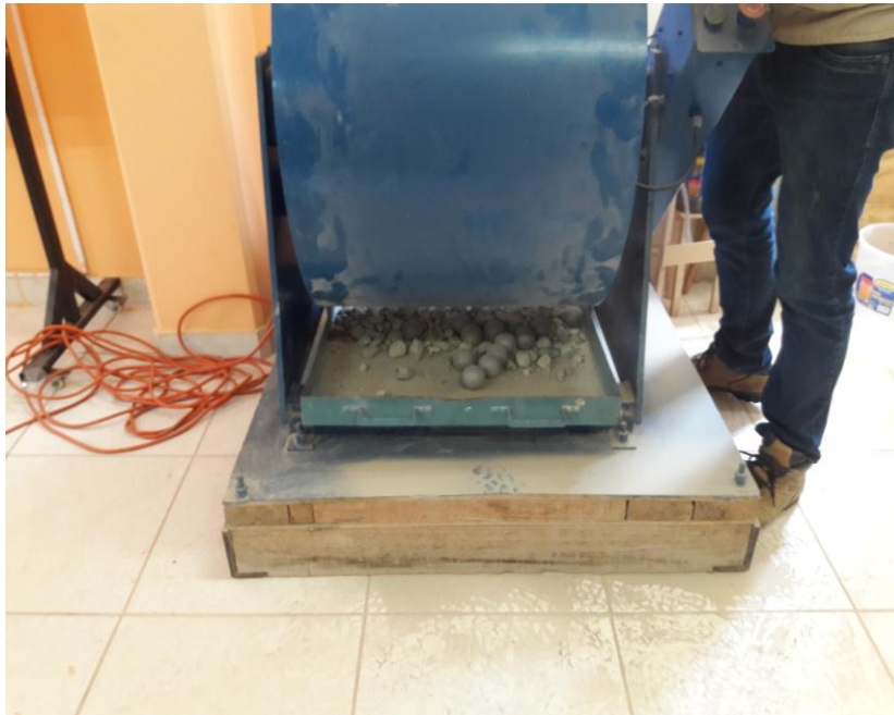
Imagen N°47: Retiro de muestra después del ensayo de abrasión
