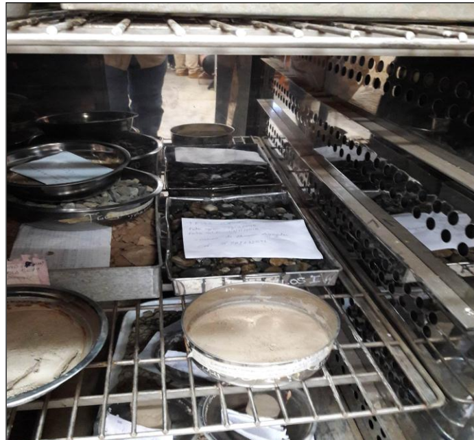
Imagen N°43: Secado de muestras en horno a 105°C
