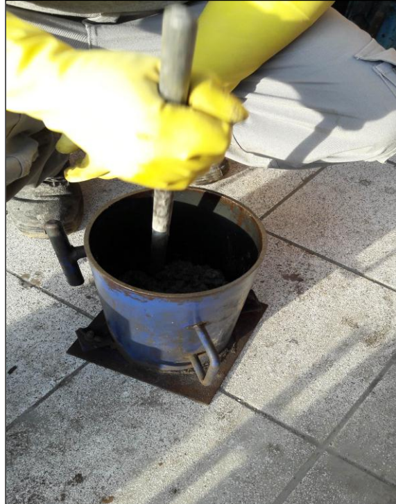
Imagen N°32: Apisonado de mezcla con varilla
