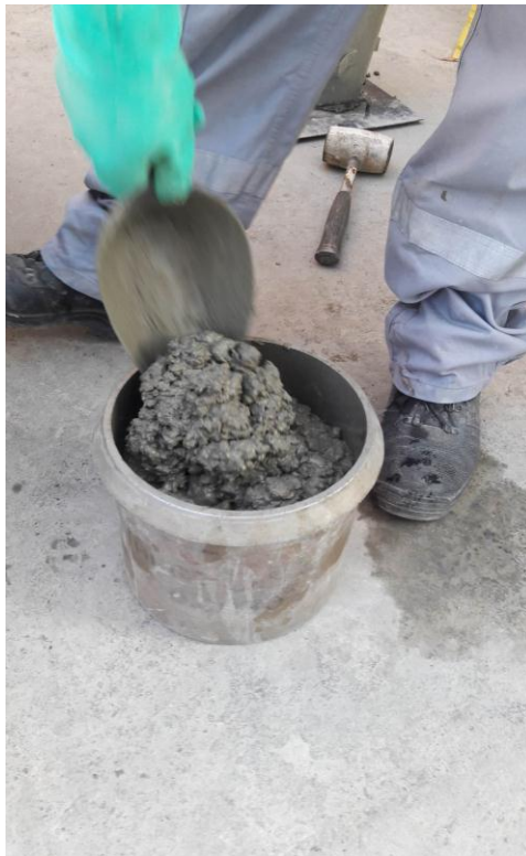
Imagen N°26: Llenado de recipiente de peso unitario con concreto fresco
