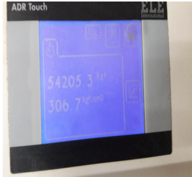
Imagen N°37: Medición de resistencia del espécimen a prueba
