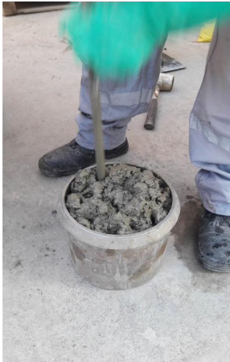
Imagen N°27: Chuseada con varilla lisa de acero 25 golpes
