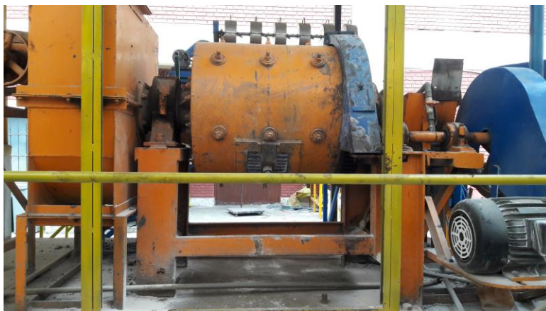
Imagen N° 5: Máquina de pulverización
