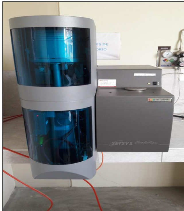
Imagen N° 9: Máquina de DTA (Polímeros UNT)
