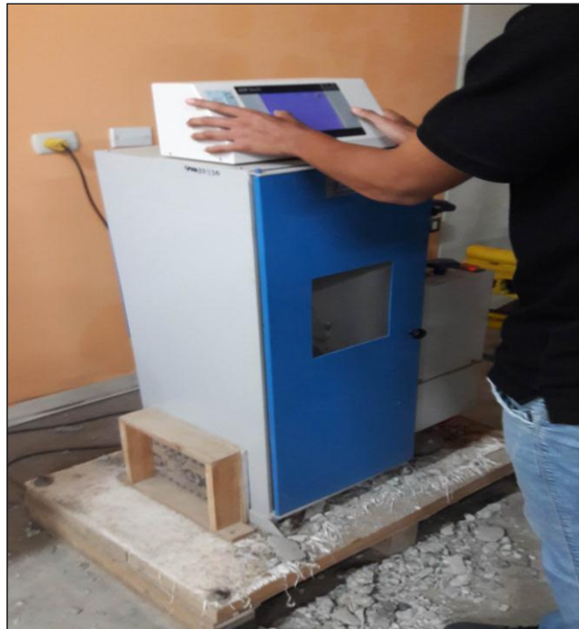
Imagen N°34: Máquina compresora ELE tipo tornillo
