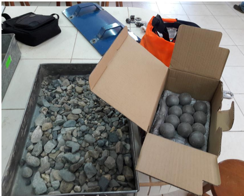
Imagen N°45: Esferas para utilizar en máquina de los ángeles
