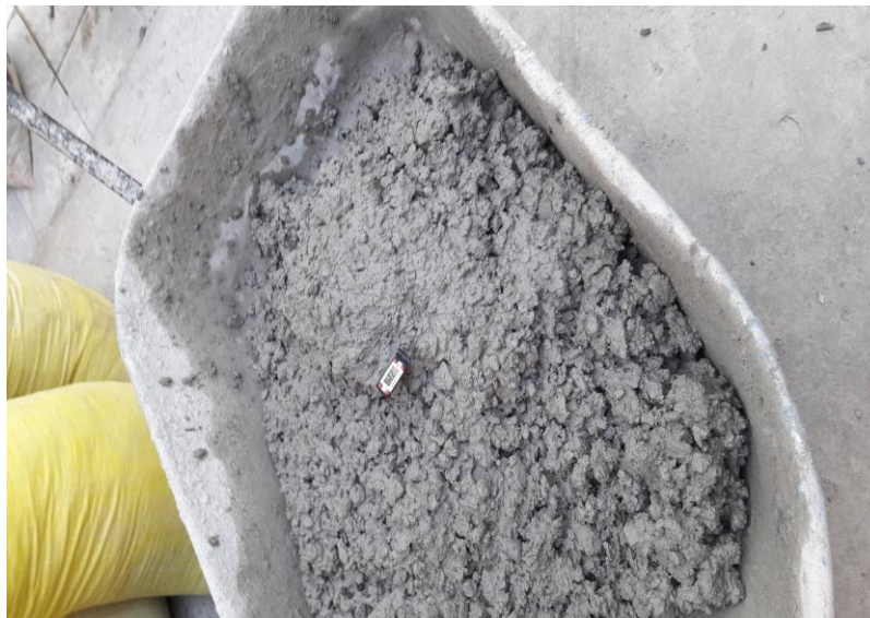
Imagen N°25: Medición de la temperatura de la mezcla
