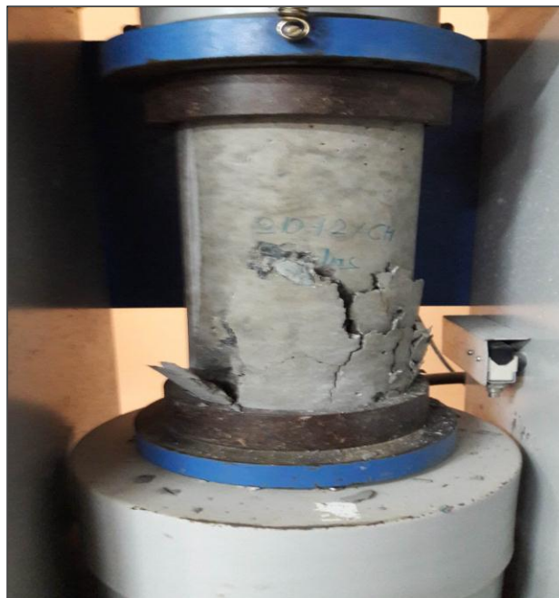
Imagen N°38: Rotura del espécimen a prueba
