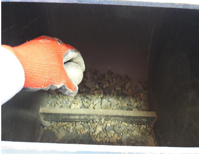
Imagen N°46: Colocación de muestra y esferas en máquina de los ángeles
