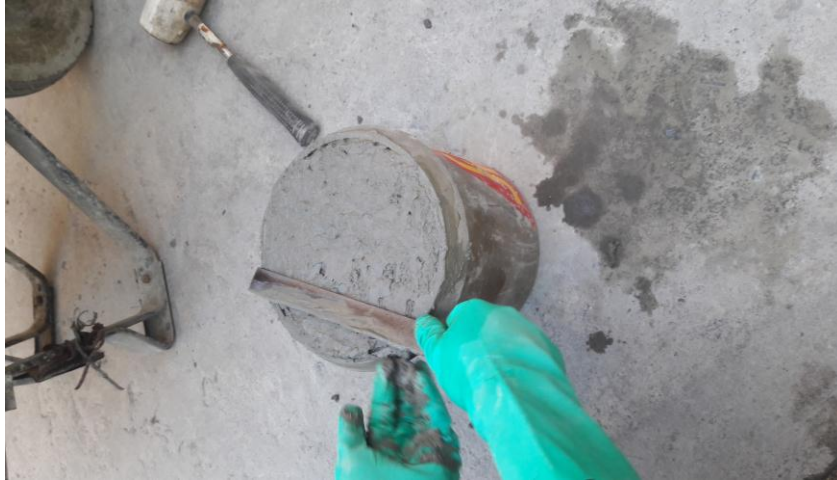
Imagen N°29: Acabado final con varilla plana
