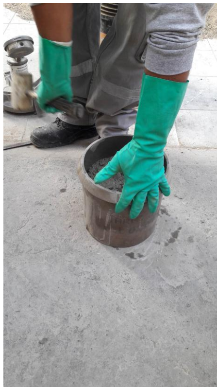
Imagen N°28: Golpe con martillo de hule en 4 vértices de recipiente
