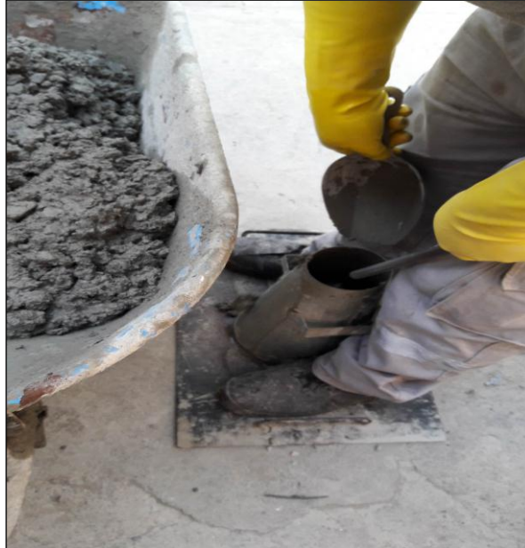
Imagen N°22: Colocación de mezcla en cono de Abrams
