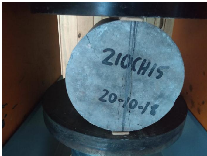
Imagen N°39: Rotura del espécimen a prueba de tracción
