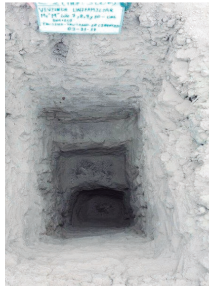
FOTO A-5-06: Vista del perfil estratigráfico de la calicata C-11, a la profundidad de 3.00 m. Nótese la presencia conformado inicialmente por material de relleno orgánico suelto, luego sigue arena pobremente graduada SP, no plástica, de poca humedad y de compacidad media. No se nota el NAF a la profundidad explorada.
