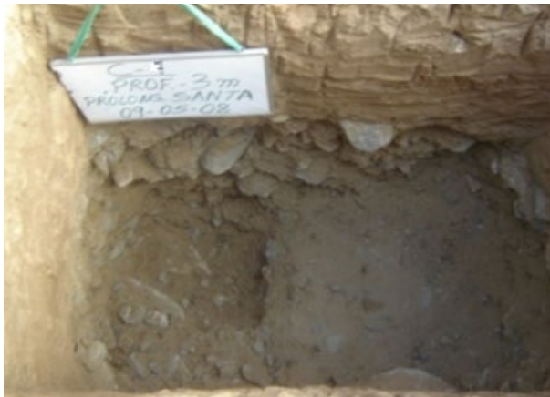
FOTO A-5-04: Vista del perfil estratigráfico de la calicata C-7, a la profundidad de 3.00 m. Nótase la presencia del relleno superficial conformado por suelo orgánico con arena suelta, luego la presencia de arena pobremente graduada (SP), de poca humedad y compacidad suelta a media, y con cierta presencia de gravillas, a medida que nos vamos profundizando y posteriormente se encuentra grava pobremente graduada (GP), de compacidad relativa media a compacta, regular humedad, con cierta presencia aislada de bolonería a medida que nos vamos profundizando. No se nota la presencia del NAF a la profundidad explorada.
