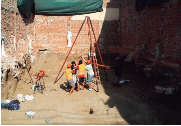
FOTO A-5-19: Vista del sondeo de exploración con el equipo de penetración estándar SPT-5, hasta los 3.75 m., ubicada en calle Samuel Morse N°665 – Urb. Pay Pay.
