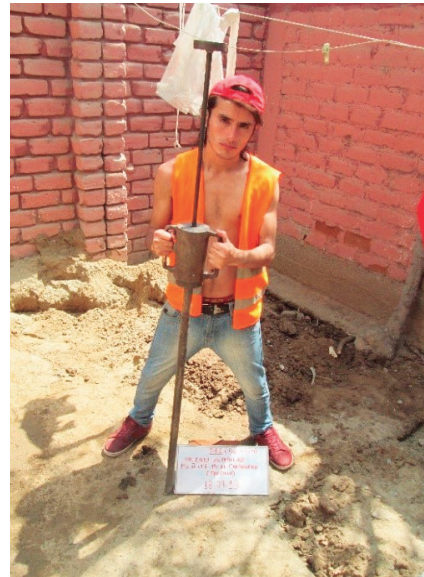
FOTO A-5-14: Vista del sondeo de exploración con el equipo de penetración dinámica ligera DPL-08, hasta la profundidad de 3.00 m., ubicada en la Urb. La Intendencia.
