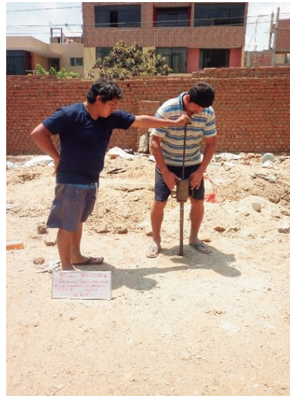
FOTO A-5-16: Vista del sondeo de exploración con el equipo de penetración dinámica ligera DPL-14, hasta la profundidad de 5.00 m., ubicada en MZ “J” - LT. 19 - calle 14 - Urb. Las Casuarinas.
