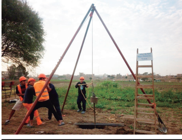
FOTO A-5-17: Vista del sondeo de exploración con el equipo de penetración estándar SPT-1, hasta los 9.00 m., ubicada en Fundo el Prisma.
