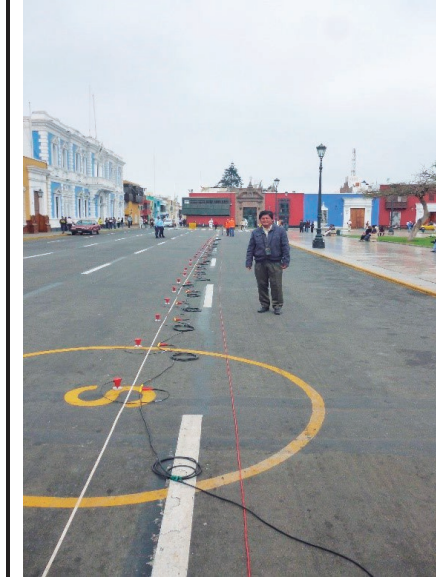
FOTO A-5-21: Vista panorámica de la línea MASW (LW-01), ubicada en la Urb. Centro Histórico.
