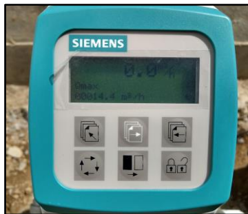
Imagen 3-42: Sensor de Flujo SITRANS FM MAG 5100W Fuente: Elaboración Propia.
