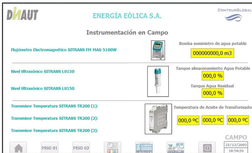
Imagen 3-31: Pantalla de Instrumentación en HMI Fuente: Elaboración Propia.
