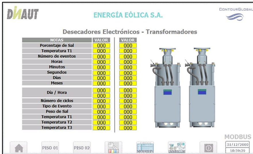
Imagen 3-30: Pantalla Modbus RTU en HMI Fuente: Elaboración Propia.
