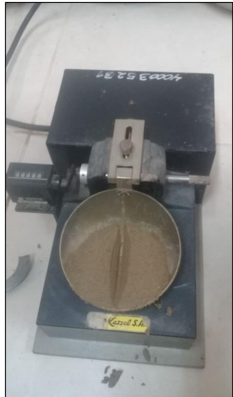
FOTOGRAFÍA N°7 Ensayo de límites de Atterberg en laboratorio UPAO.
