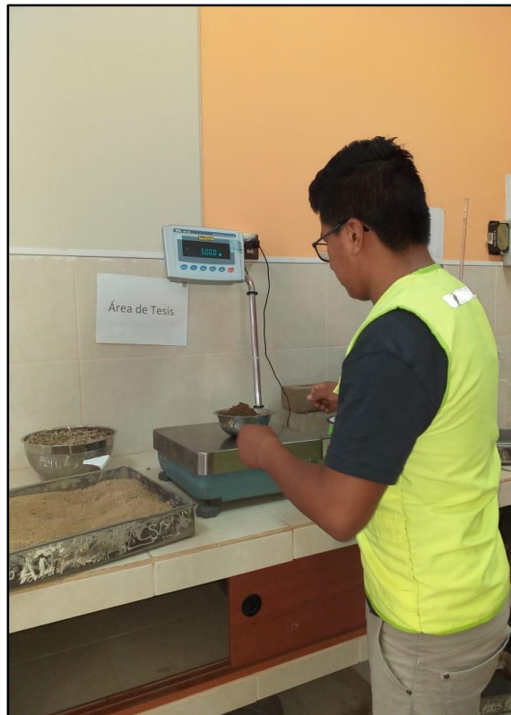
FOTOGRAFÍA N°5 Ensayo de humedad en laboratorio UPAO.
