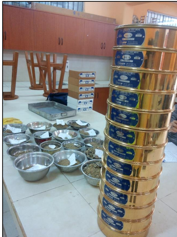
FOTOGRAFÍA N°6 Ensayo de granulometría en laboratorio UPAO.
