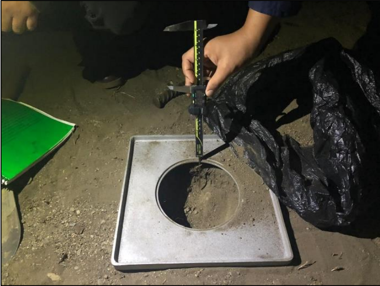
FOTOGRAFÍA N°9 Ensayo de densidad de campo, método cono de arena.
