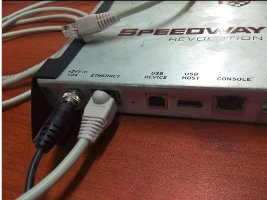
Ilustración 47: Conexión de cable de red a dispositivo Reader. (Elaboración propia)
