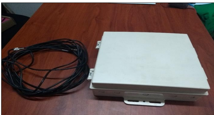
Ilustración 11: Gabinete con Categoría IP67 para outdoor de tamaño 10x10x4 pulgadas incluye antenas polarizadas RFID (Elaboración propia)
