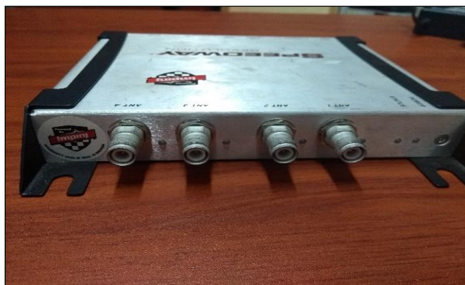
Ilustración 10: Lector/Reader RFID con cuatro puertos (Elaboración propia)
