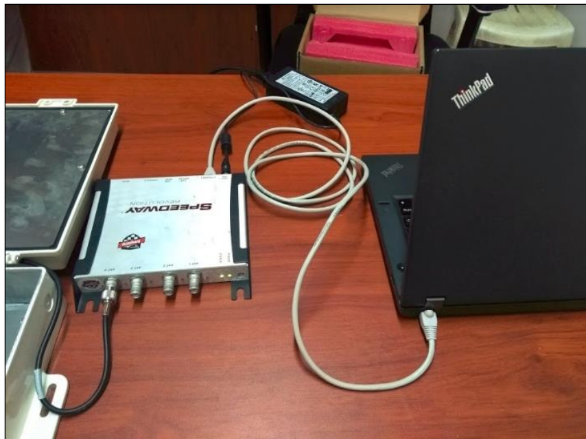
Ilustración 48: Conexión de cable de red entre dispositivo Reader y Computador. (Elaboración propia)
