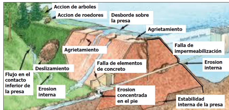
Ilustración 2: fallas comunes en las presas
