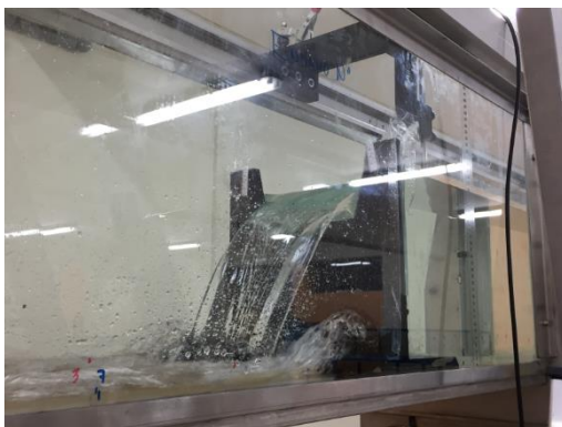
Figura 4. 2: Vertedero Cipolletti - Descarga Libre.
