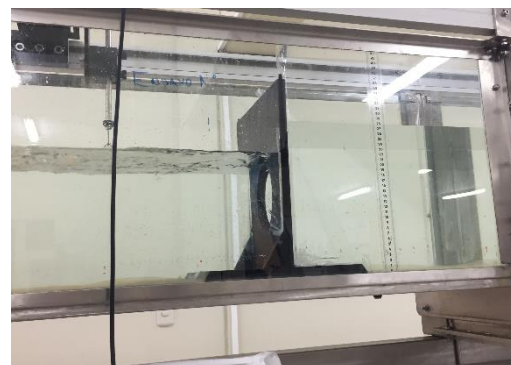
Figura 4. 3: Orificio – Descarga totalmente sumergida
