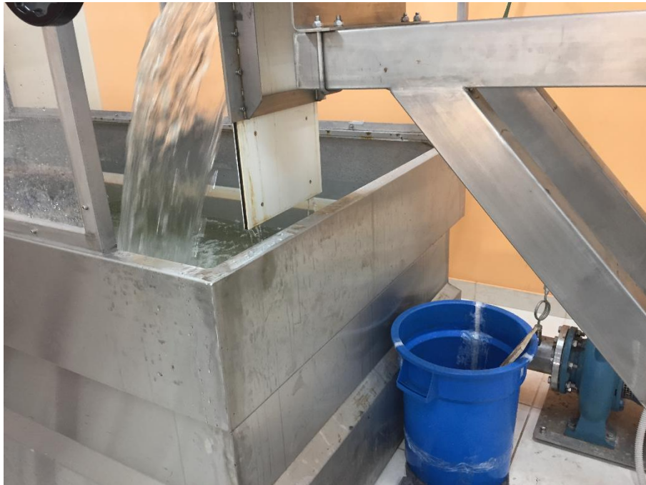
Figura 4. 1: Aforo volumétrico con recipiente graduado.
