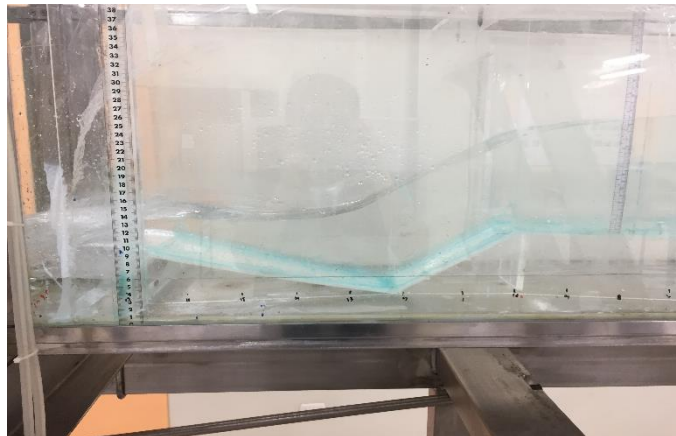
Figura 4. 4: Aforador Parshall – Descarga libre.
