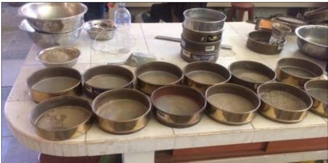
Tamices empleados para la granulometría de Agregados Fino: 3/8, N° 04, N° 08, N° 10, N° 16, N° 20, N° 30, N° 40, N° 50, N° 60, N° 80, N° 100 y N° 200
