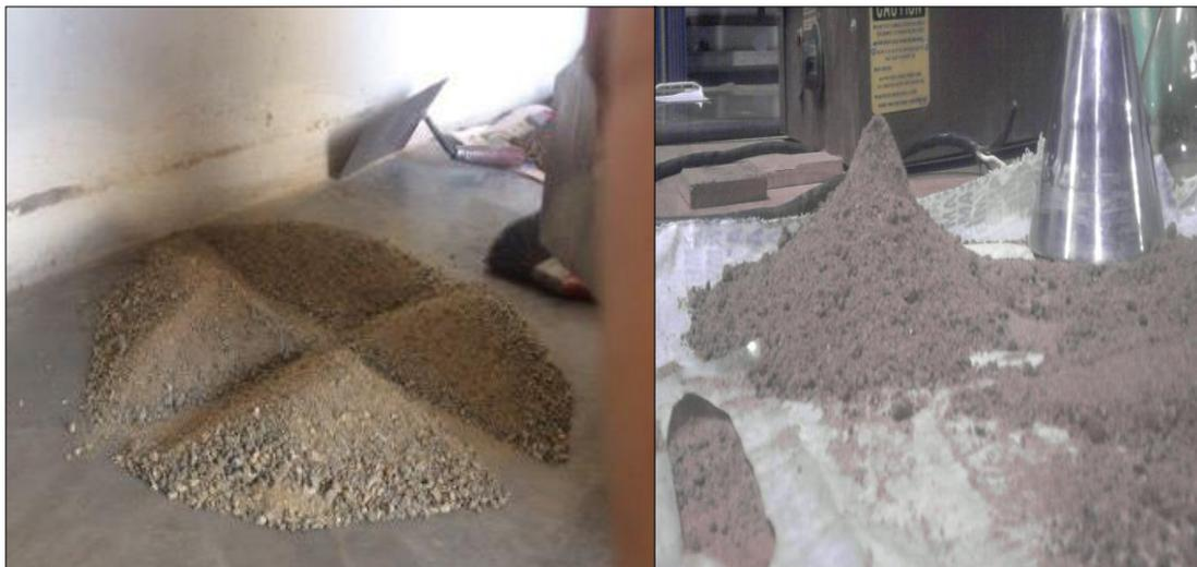
Cuarteo de muestra de Agregado Fino y verificación de su estado parcialmente saturada
