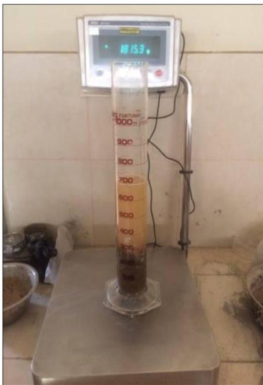
Muestra para determinar la gravedad específica
