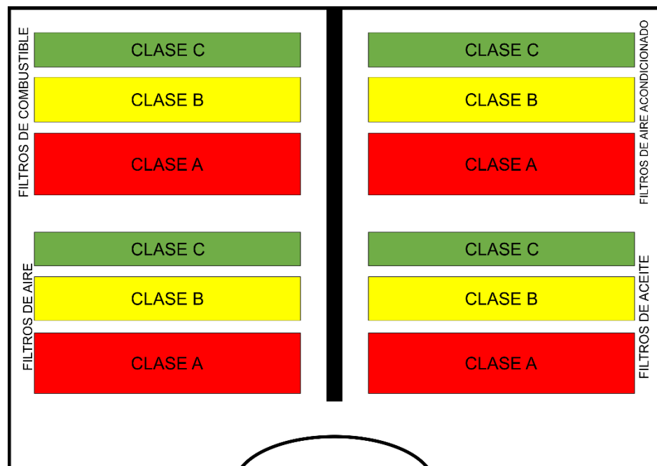
Figura 40: Nueva distribución de filtros, según sus presentaciones en el almacén en la empresa EVOLUTION CAR SERVICE E.I.R.L. Elaboración propia de autores.
