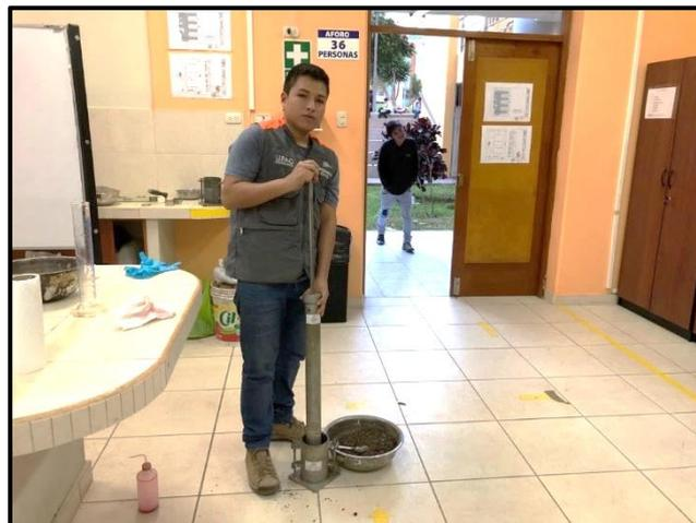
Ensayo de Proctor modificado y CBR para determinar la densidad seca máxima y el contenido óptimo de humedad.
