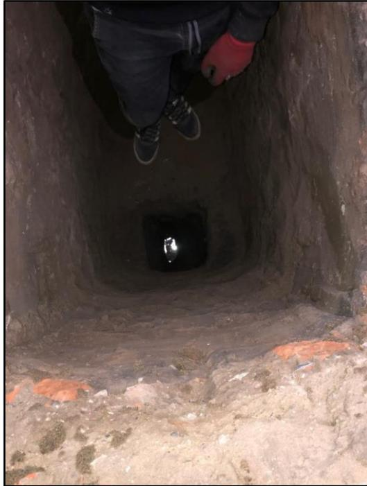
La calicata C-3 presento un nivel freático a una profundidad de 2.00 m. También, se observó que la muestra de suelo extraída es de tipo arenosa.
