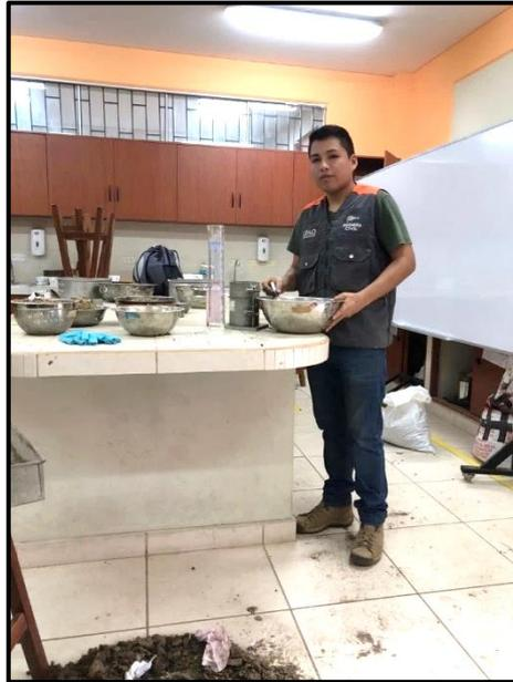
Preparación de la muestra para realizar el ensayo de Proctor modificado.
