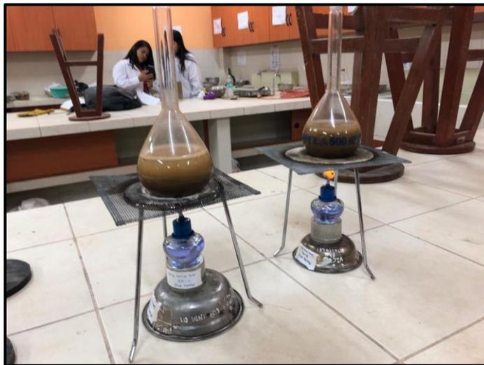
Determinación de la gravedad específica de sólidos.
