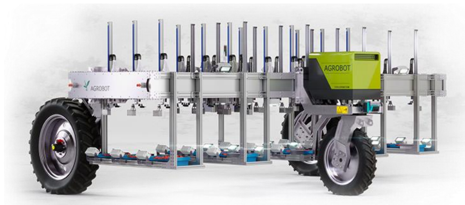
Figura 7. Proyecto AGROBOT diseñado para la recolección de fresa de manera automática.
