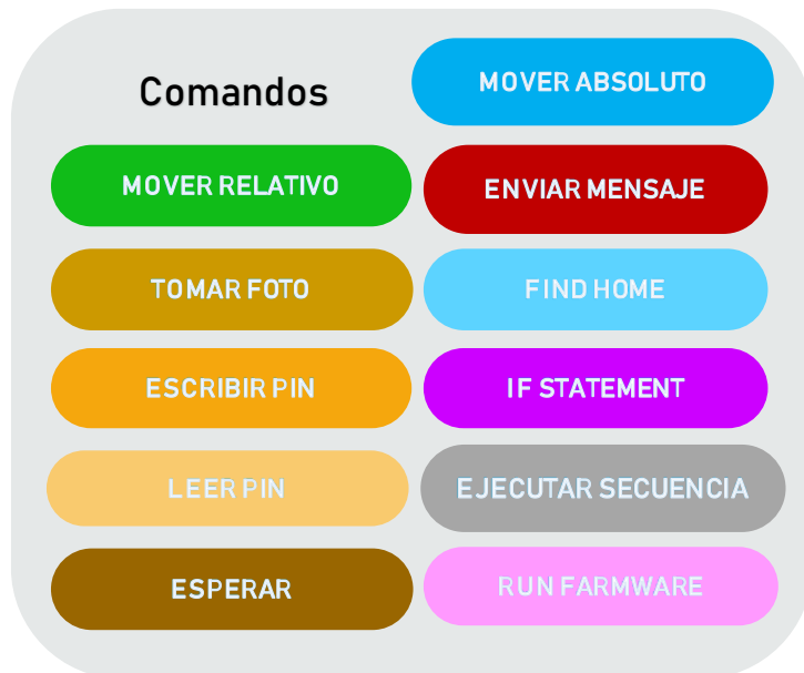
Figura 22. Lista de comandos de programación para el planeamiento de trayectoria del robot, junto con el color de cada comando
