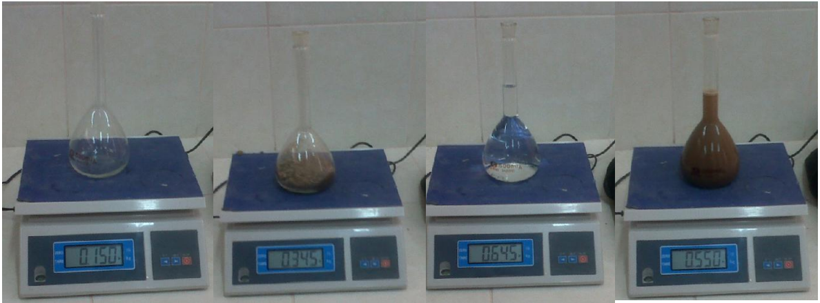
Foto 1.- Peso Específico, método de la Fiola al agregado fino.
