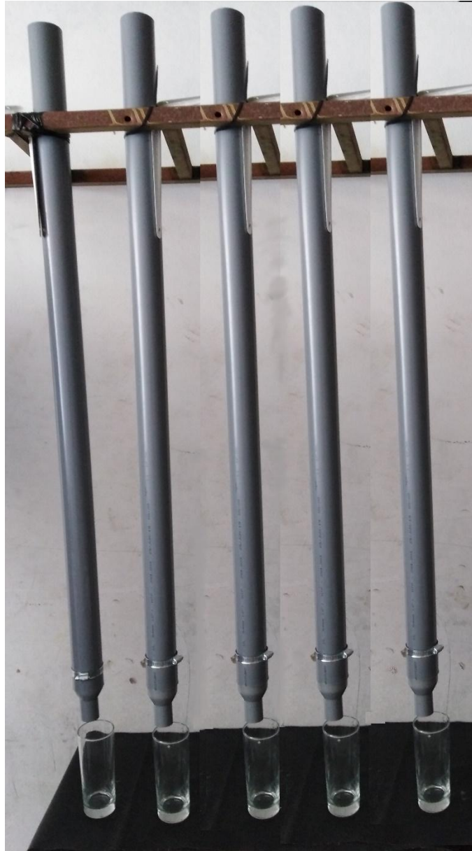
Foto 8.- Ensayo no estandarizado de permeabilidad.
