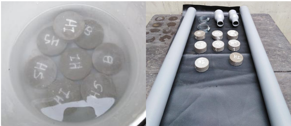
Foto 6.- curado de probetas de 5 cm de diámetro y materiales para pruebas de permeabilidad.
