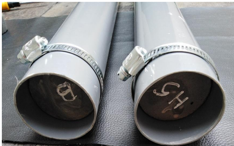
Foto 7.- Colocación de probeta, sellado y ajuste en columna de ensayo de permeabilidad.
