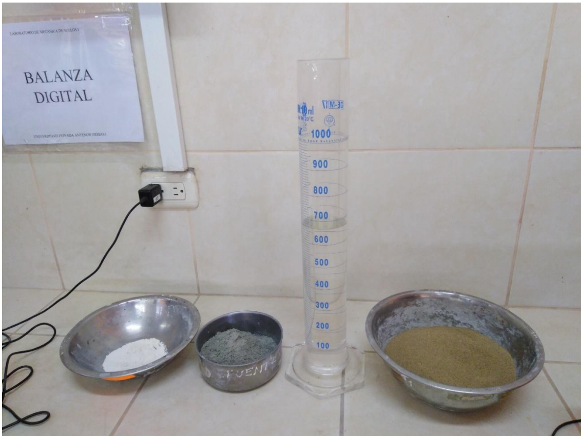
Foto 2.- Aditivo, cemento, agua y agregado fino pesado según diseño de mezcla, para preparación de probetas.
