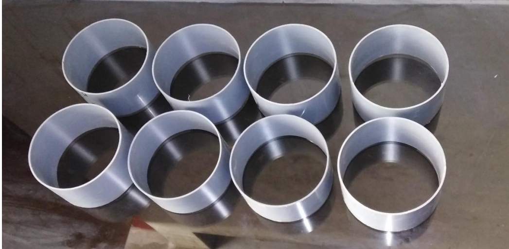
Foto 3.- Moldes usados para la preparación de probetas de mortero de cemento.
