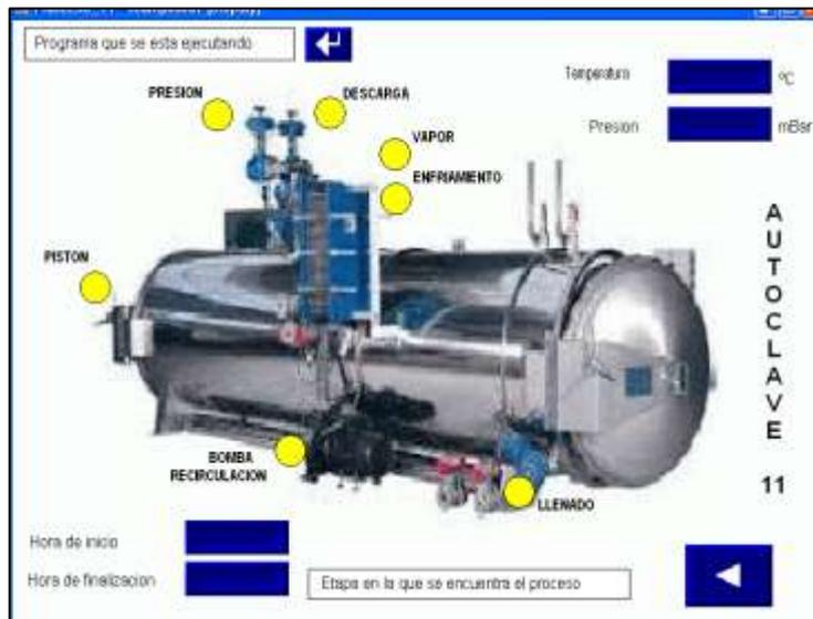
Figura. N° 4.9: Pantalla de proceso de la autoclave N° 11.
