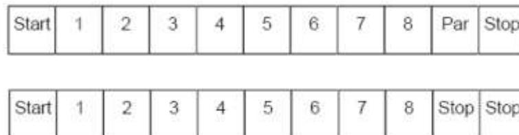
Figura N° 2.15: Secuencia de bits en modo RTU con y sin chequeo de paridad
