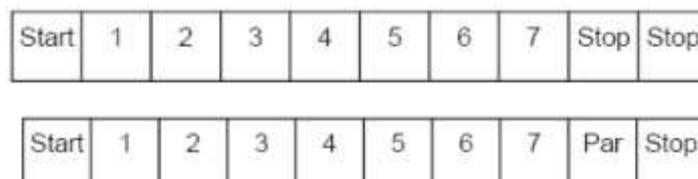
Figura N° 2.17: Secuencia de bits modo ASCII con y sin chequeo de paridad.
