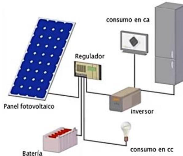
Imagen N°22: Componentes de Paneles Solares.
