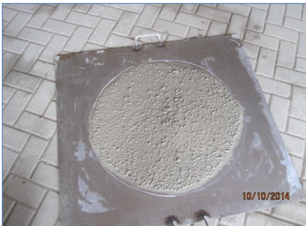
FOTO N°11 Ensayo de extensibilidad, Diámetro máximo
