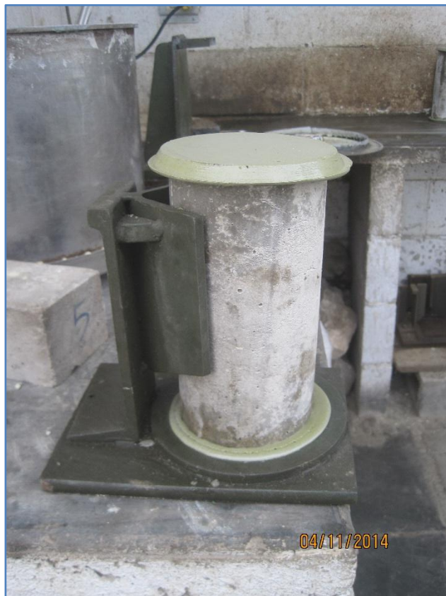
FOTO N°17 Capiando los testigo para la rotura
