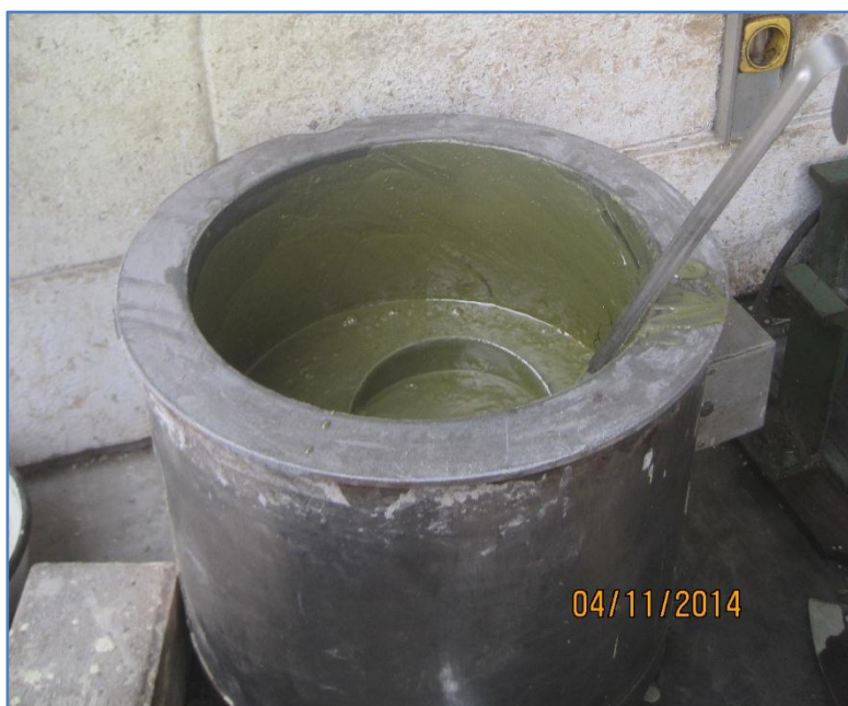
FOTO N°4 Olla Eléctrica para preparación de la bentonita con Azufre
