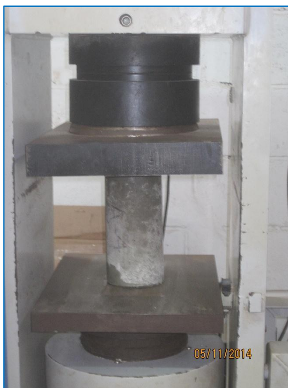
Figura 2.7: Ensayo Resistencia a la Compresión
