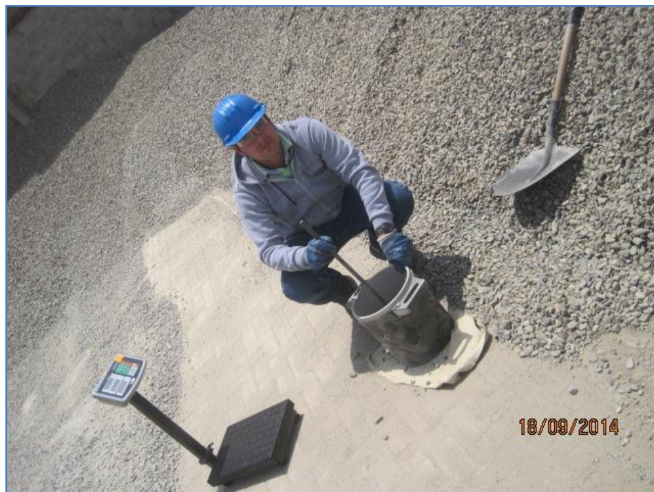
FOTO N°7 Determinando el Peso Unitario del Agregado Grueso.
