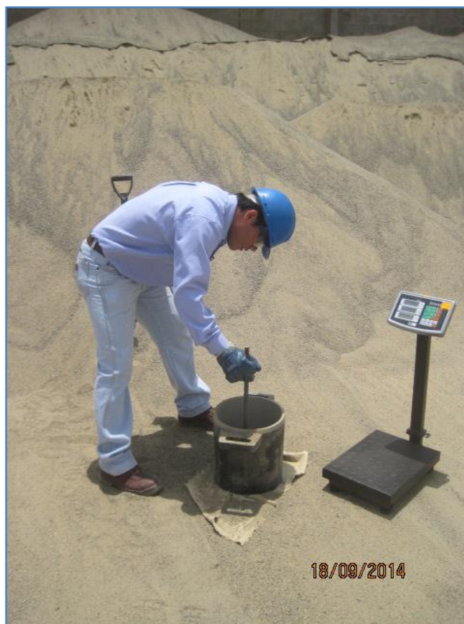
FOTO N°8 Determinando el Peso Unitario del Agregado Fino
