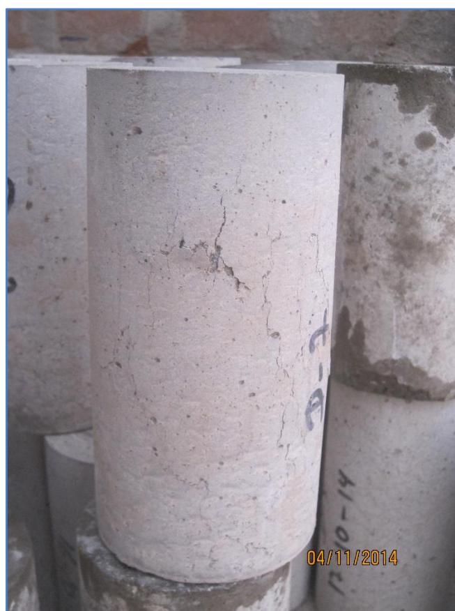
FOTO N°20 Testigo después de ensayo la rotura
