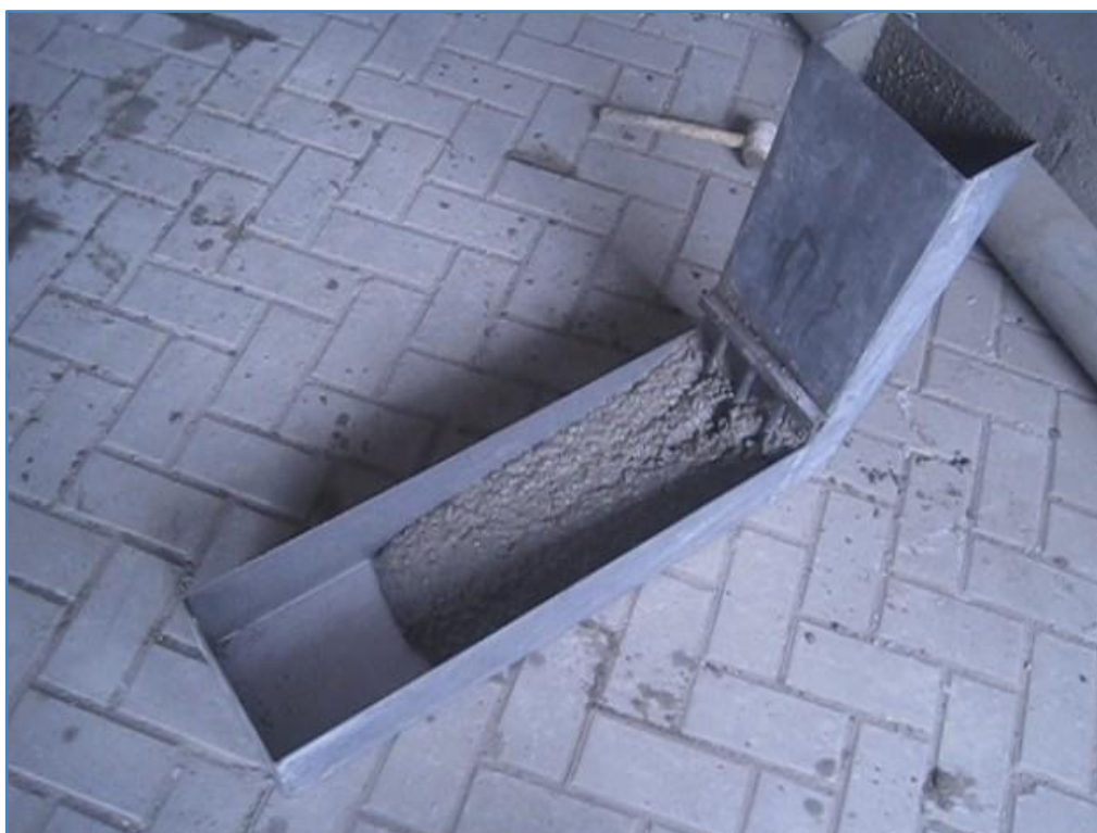
FOTO N°14 Ensayo Caja L
