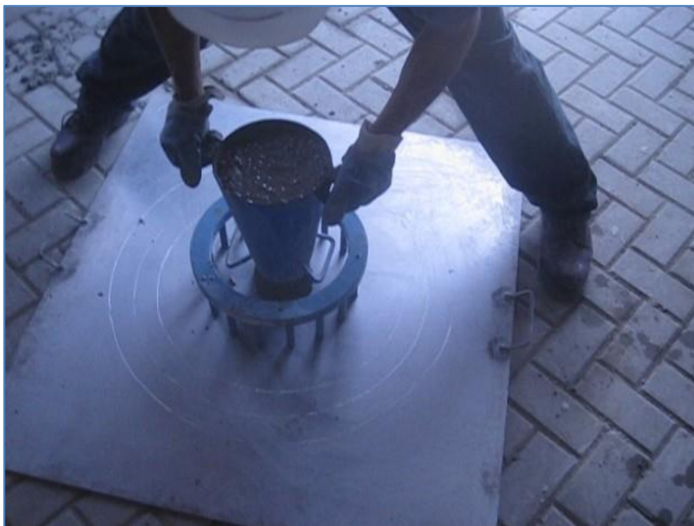
FOTO N°13 Ensayo del Anillo Japonés
