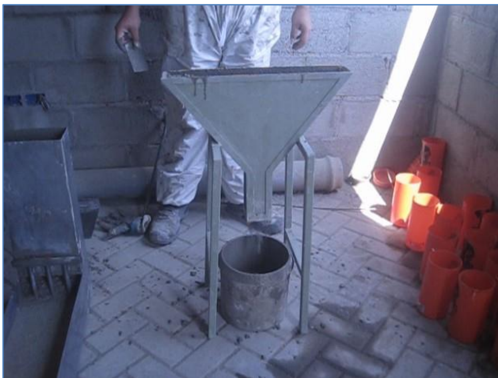
FOTO N°12 Ensayo del embudo V
