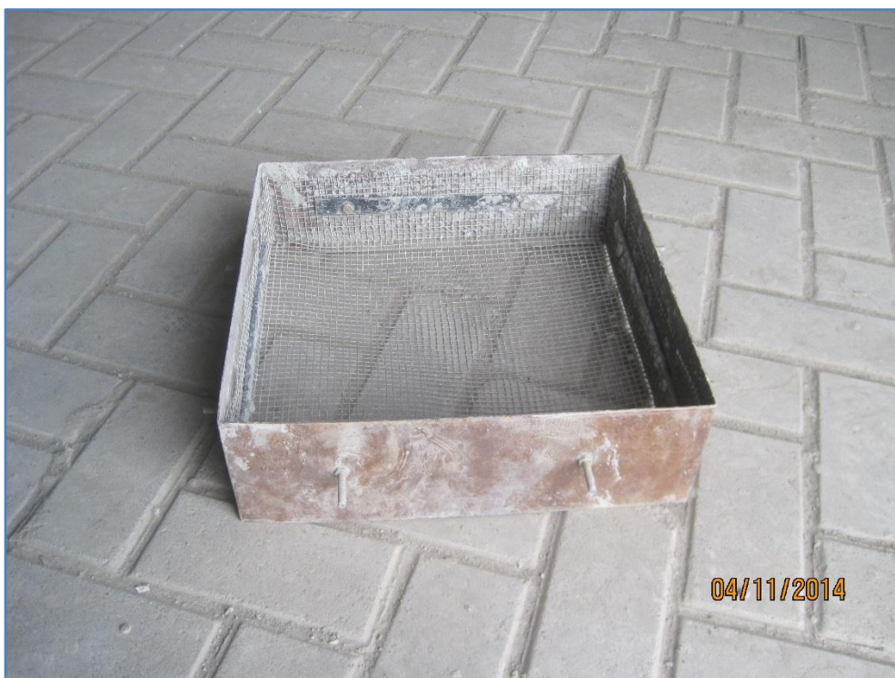
FOTO N°15 Tamiz 5mm para ensayo estabilidad del tamiz GTM
