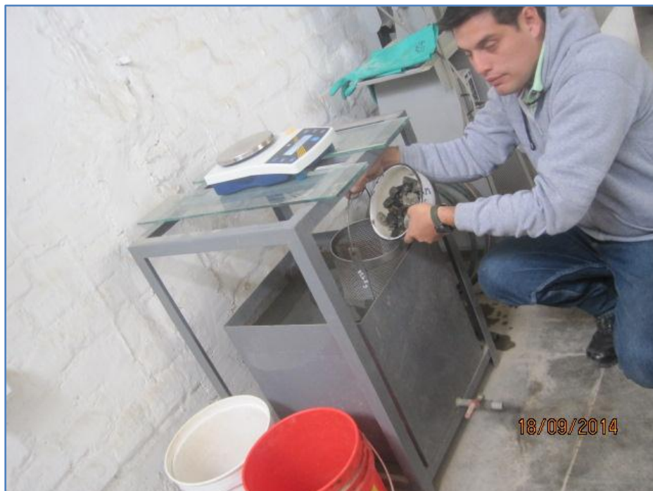
FOTO N°6 Determinando el peso sumergido de la muestra saturada de agregado Grueso.
