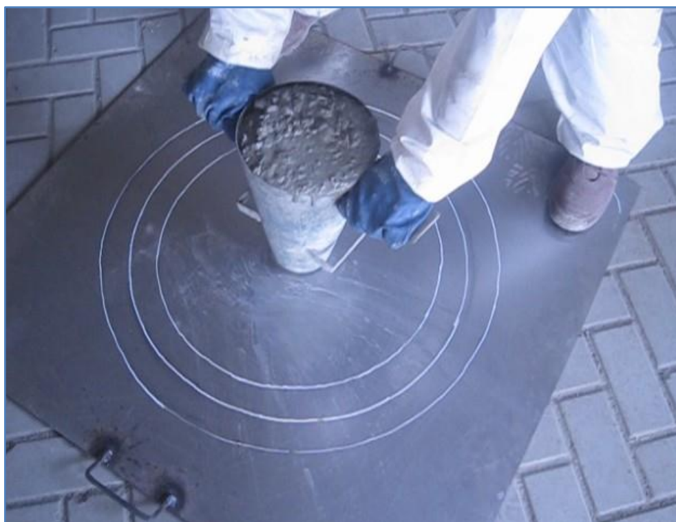
FOTO N°10 Ensayo de Extensibilidad con el Cono invertido
