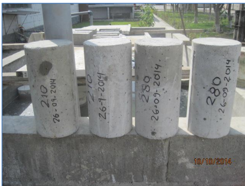
FOTO N°18 testigos después del curado.
