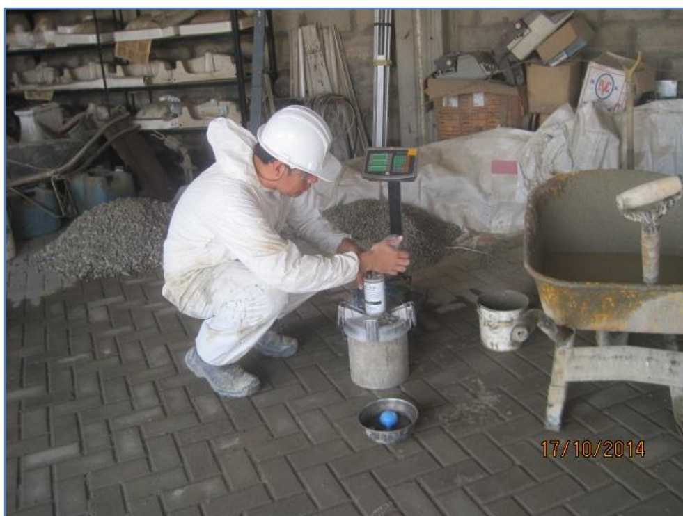
FOTO N°16 Determinación del contenido de aire del CAC
