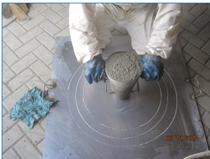
Figura 2.3: Ensayo de Extensión de Flujo Fuente Propia
