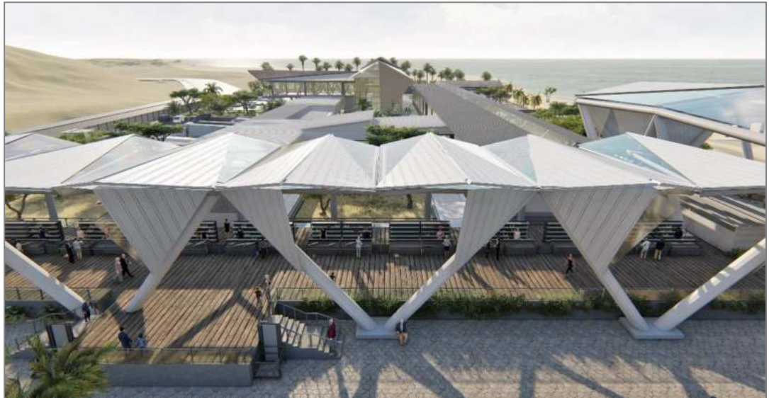
Imagen N° 60 y N° 61: Renders de vistas generales al bloque estructural semi-abierto de la zona comercial minorista, formado por la repetición de módulos en hilera (tijerales), y techado con cubiertas metálicas plegables. Fuente: Elaboración propia.
