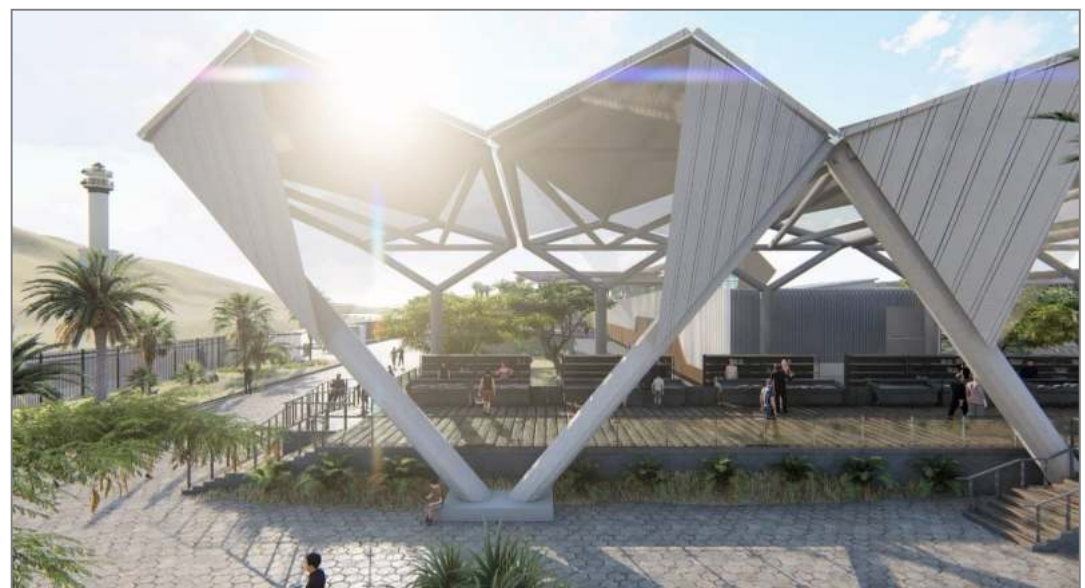
Imagen N° 62: Render de perspectiva a fachada longitudinal, con vista close-up al módulo estructural "V" con vigas diagonales y los distintos accesos a la pasarela comercial. Fuente: Elaboración propia.
