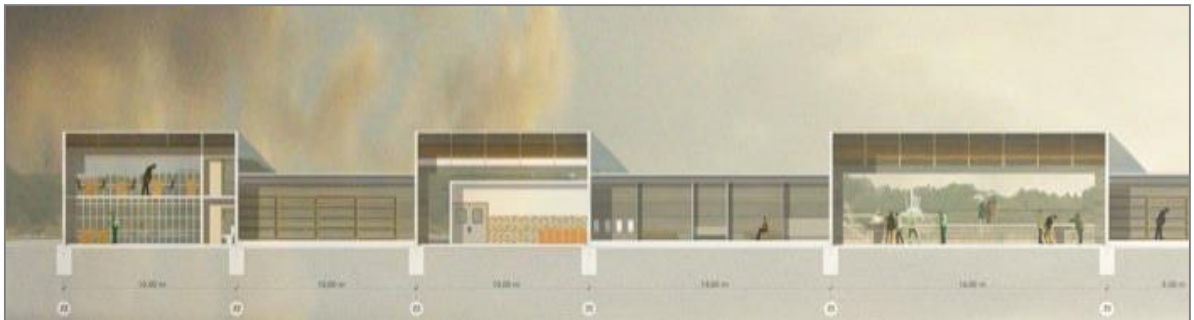
Imagen N°12: Corte Longitudinal área productiva/comercial, con tipología modular.
