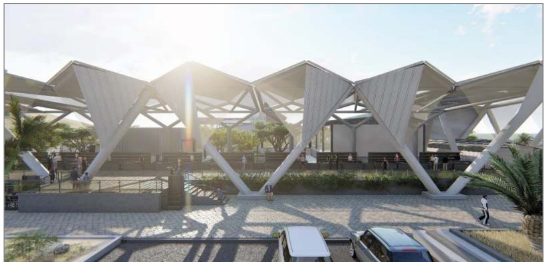
Imagen N° 62: Render de perspectiva a fachada longitudinal, con vista close-up al módulo estructural "V" con vigas diagonales y los distintos accesos a la pasarela comercial. Fuente: Elaboración propia.
