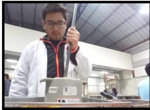
FIGURA N° 8: Uso de la varilla de compactación para el cálculo del P.U.C
