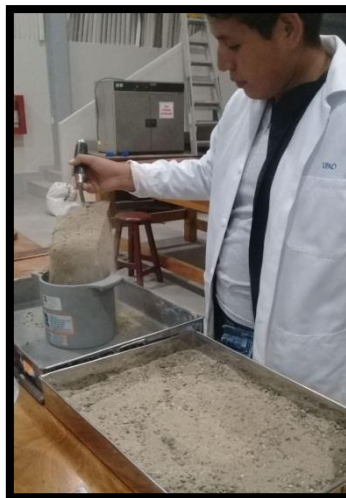
FIGURA N° 7: Llenado del recipiente con arena gruesa
