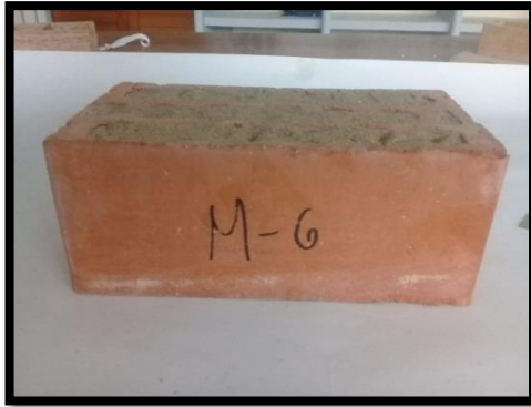
FIGURA N° 34: Unidad de albañilería rellena de arena
