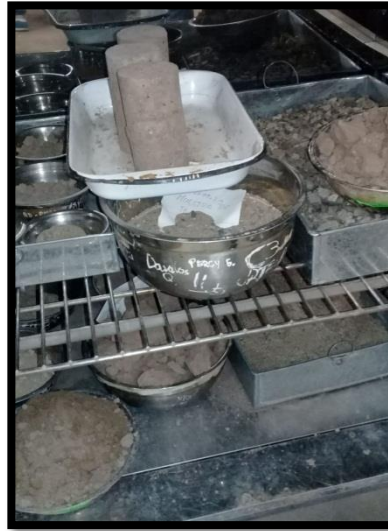
FIGURA N° 10: Proceso de secado en horno de 500 g de arena gruesa
