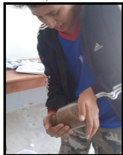
FIGURA N° 18: Agitación manual del picnómetro
