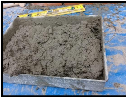
FIGURA N° 51: Preparación del mortero de dosificación 1:5
