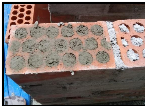
FIGURA N° 70: Proceso de relleno de las esquinas de los muretes con un mortero de dosificación 1:3
