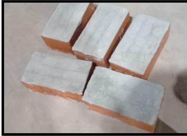
FIGURA N° 40: Unidades de albañilería recapeadas
