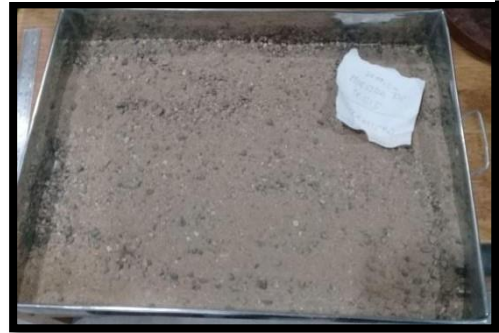
FIGURA N° 13: Arena gruesa extendida a lo largo de la bandeja
