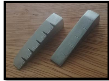
FIGURA N° 25: Cuñas de medición de alabeo del ladrillo
