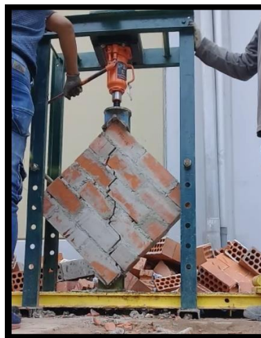
FIGURA N° 75: Forma de falla del murete de albañilería asentado con mortero tradicional
