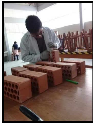
FIGURA N° 22: Medida de las dimensiones de la unidad de albañilería
