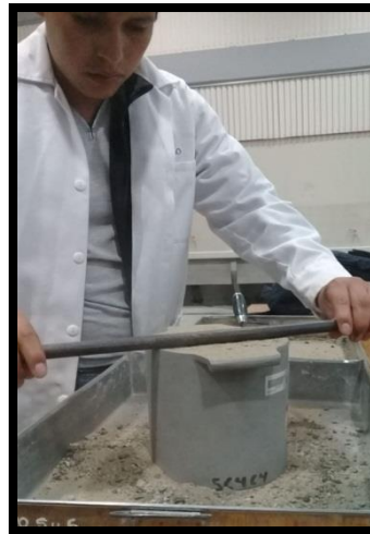
FIGURA N° 9: Proceso de enrasado de la arena gruesa con la varilla de compactación
