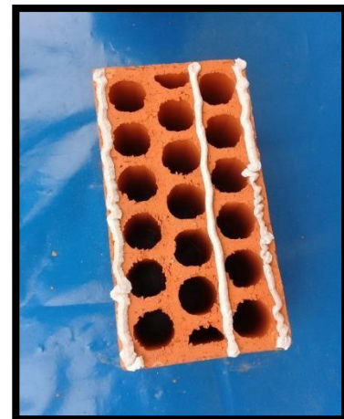
FIGURA N° 45: Pilas unidas con 3 cordones de Massa Dun Dun
