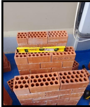
FIGURA N° 60: Nivelación de los muretes unidos con Massa Dun Dun
