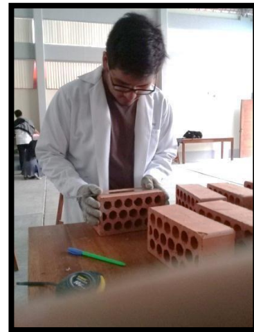
FIGURA N° 23: Medida del largo de la unidad de albañilería
