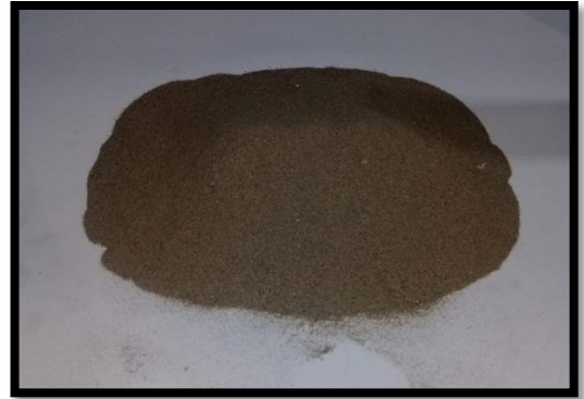
FIGURA N° 35: Cantidad de arena que cabe en un ladrillo de 18 huecos
