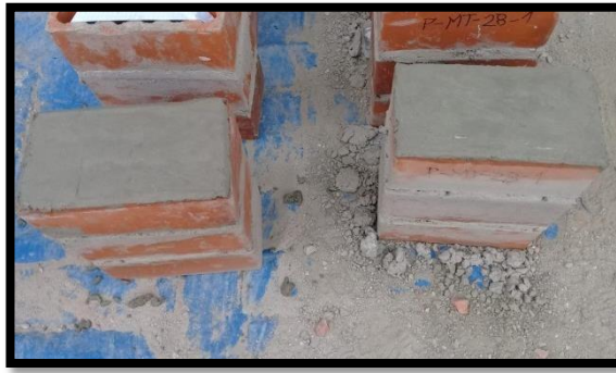
FIGURA N° 54: Pilas de albañilería recapeadas
