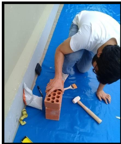
FIGURA N° 44: Construcción de las pilas unidas con Massa Dun Dun
