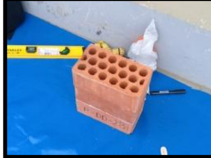
FIGURA N° 46: Pila de albañilería de 3 ladrillos de altura
