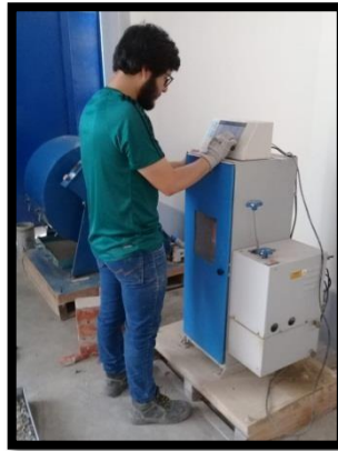
FIGURA N° 57: Ensayo de compresión axial mediante la prensa hidráulica
