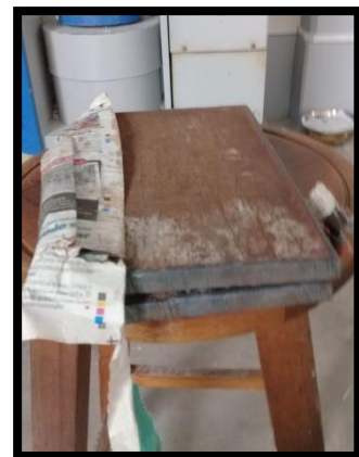
FIGURA N° 48: Placa de acero colocada en la parte inferior de la pila
