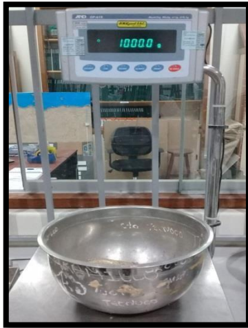
FIGURA N° 12: Cantidad de arena gruesa seca utilizada en el ensayo
