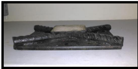
FIGURA N° 49: Placa de acero colocada en la parte superior de la pila
