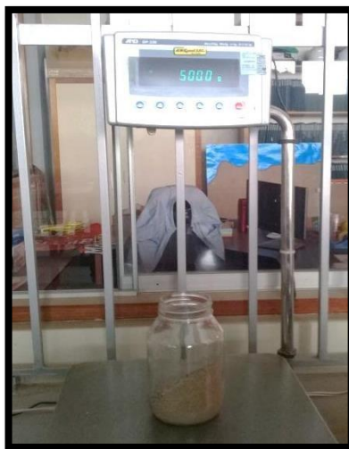
FIGURA N° 17: Peso de 500 g de arena gruesa en el picnómetro
