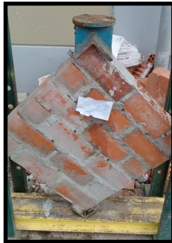
FIGURA N° 74: Instalación de los muretes con mortero tradicional en el marco de compresión
