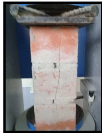
FIGURA N° 55: Forma de falla de pila de albañilería asentada con mortero tradicional
