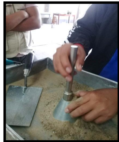
FIGURA N° 15: Apisonado de la arena gruesa para comprobar un secado homogéneo
