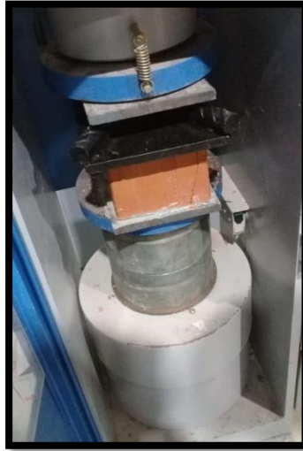
FIGURA N° 41: Unidad de albañilería dentro de la prensa hidráulica
