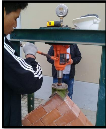
FIGURA N° 66: Aplicación de la carga constante mediante la gata hidráulica
