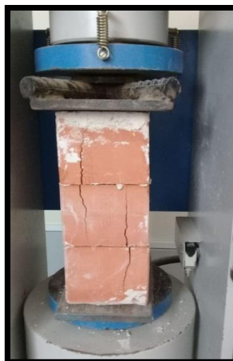
FIGURA N° 50: Forma de falla de pila de albañilería unida con Massa Dun Dun
