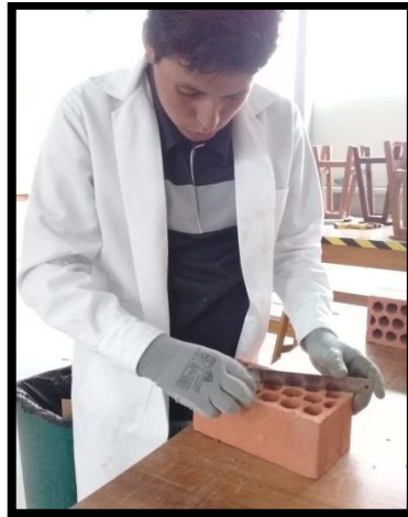
FIGURA N° 27: Ensayo de medida de convexidad de las unidades de albañilería
