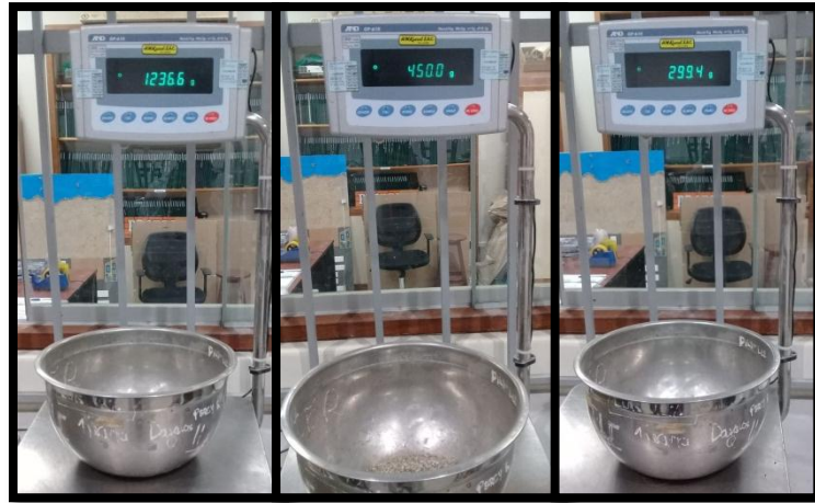
FIGURA N° 5: Peso del material retenido en cada tamiz
