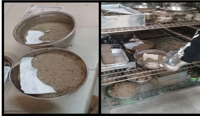
FIGURA N° 3: Cantidad de arena gruesa para ensayo y procedimiento de secado
