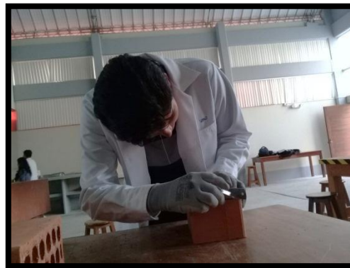
FIGURA N° 26: Proceso de la medida de la concavidad de las unidades de albañilería
