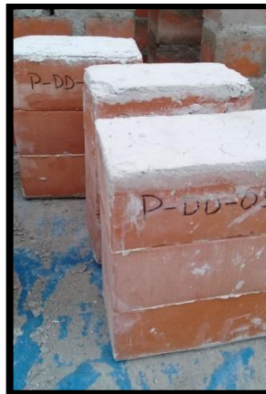
FIGURA N° 47: Pilas unidas con Massa Dun Dun recapeadas
