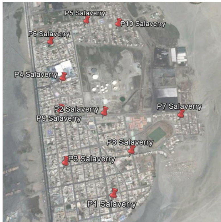
Figura 4.3. Zona geográfica en el distrito de Salaverry donde el nivel de recepción está por debajo del umbral de 74 dBV/m.
