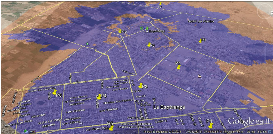
Figura 4.24. Cobertura de la estación repetidora La Esperanza.
