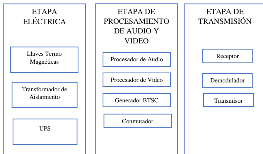
Figura 3.13. Etapas del Equipamiento de las Estaciones Repetidoras
