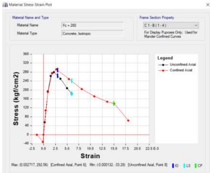
Figura 25: Diagrama Esfuerzo vs Deformación del Concreto Confinado.
