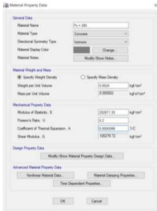
Figura 20: Propiedades del Concreto f_c = 280 \text{ kg/cm}^2
