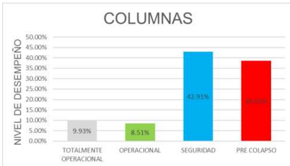
Figura 81: Nivel de desempeño en columnas en 10G.
