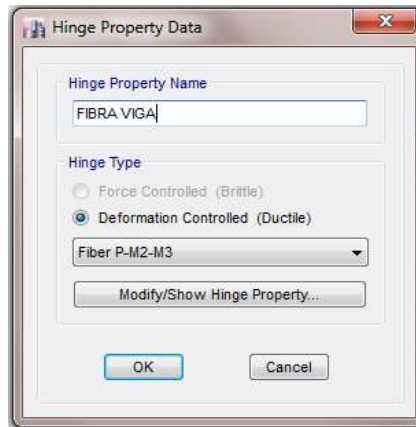
Figura 39: Se establece las rotulas plásticas para vigas.
