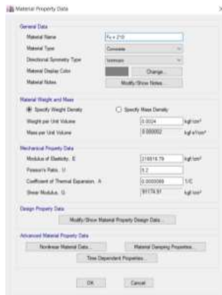
Figura 19: Propiedades del Concreto f_c = 210 \text{ kg/cm}^2
