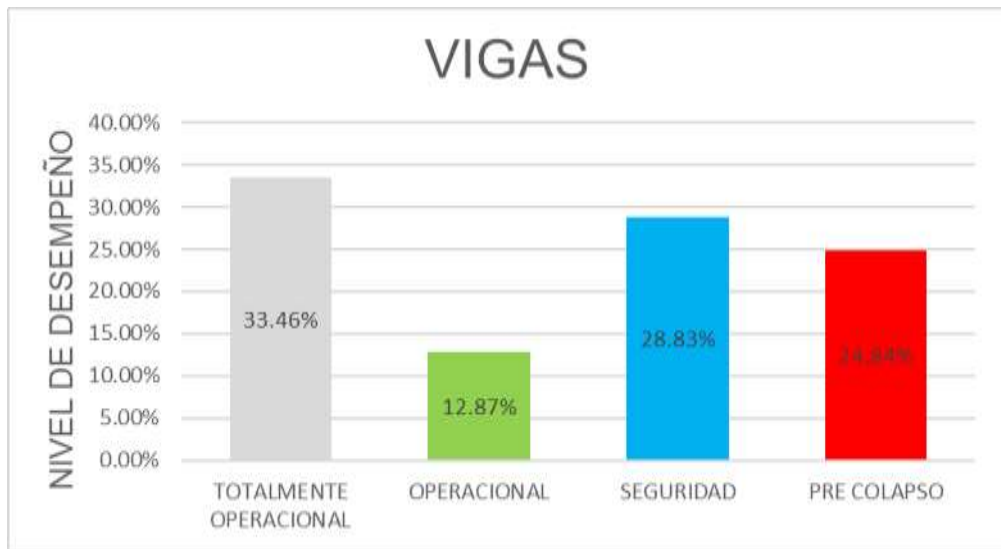
Figura 77: Nivel de desempeño en vigas en 8G.
