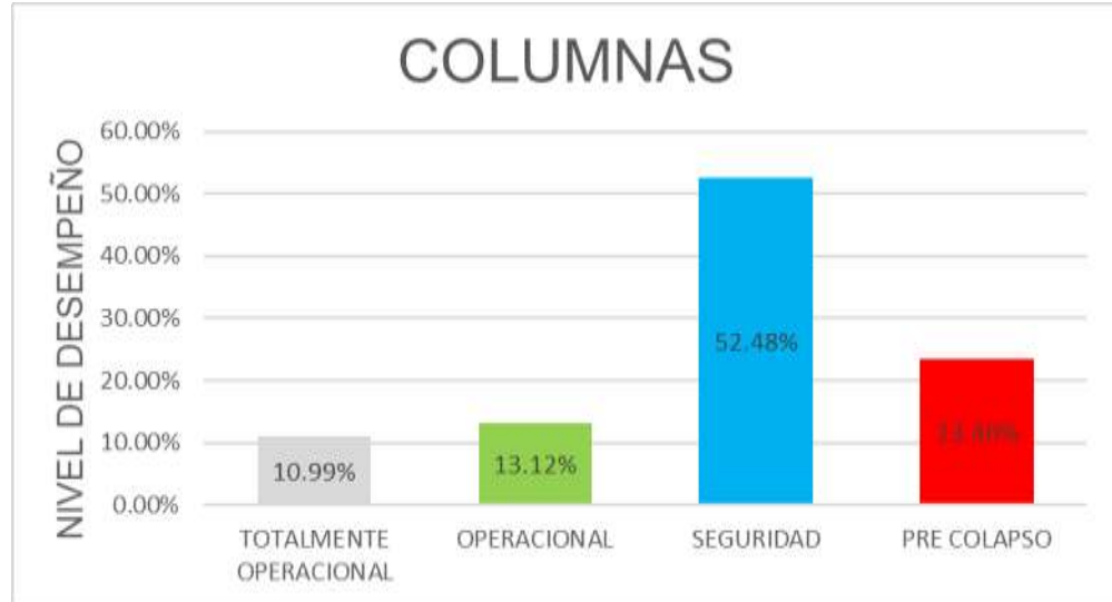
Figura 76: Nivel de desempeño en columnas en 8G.
