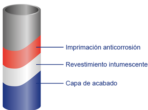
IMAGEN N° 82: Esquema de las partes del revestimiento en acero
