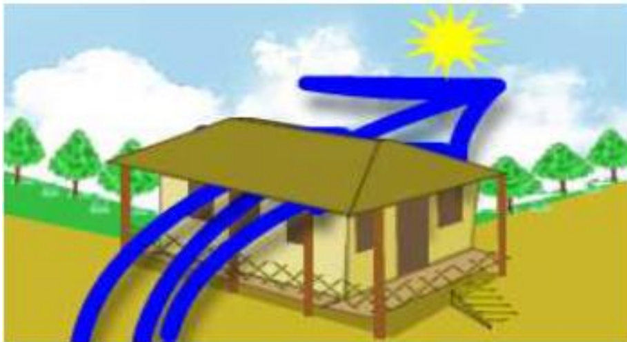
GRAFICO Nº41: Criterio de diseño bioclimático en función del viento en climas muy calidos y humedos
