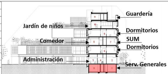
El muro de la fachada es de madera enmarcada en metal mientras que los pilares, vigas y suelo son de hormigón. La estructura de hormigón de vigas y pilares en toda la construcción permiten un cierto grado de flexibilidad.
