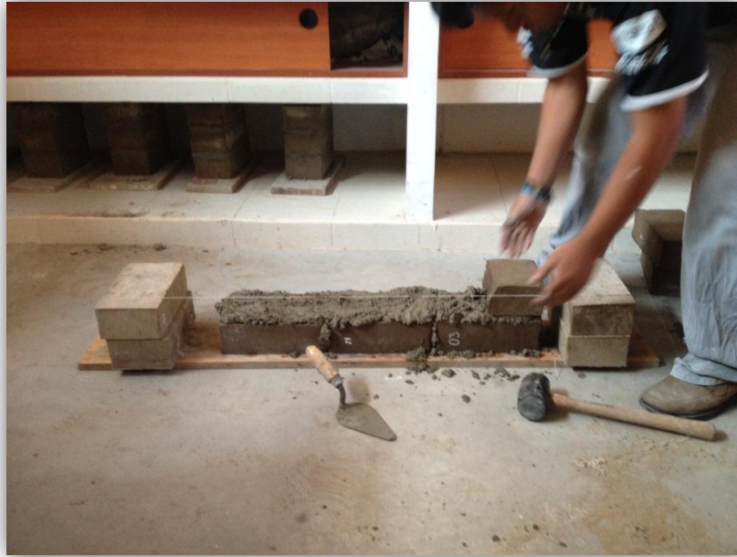
Figura N° 22: Asentando la media unidad de albañilería en la parte extrema del murete
