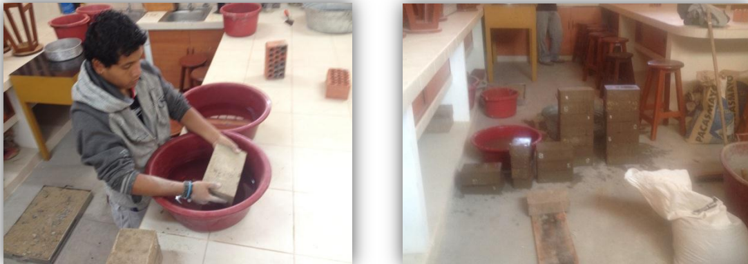
Figura N° 20: Humedeciendo las unidades de Suelo-Cemento
