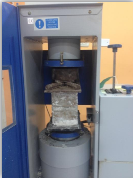
Figura N° 37: Ensayo y forma de falla para pilas de 2 hileras
