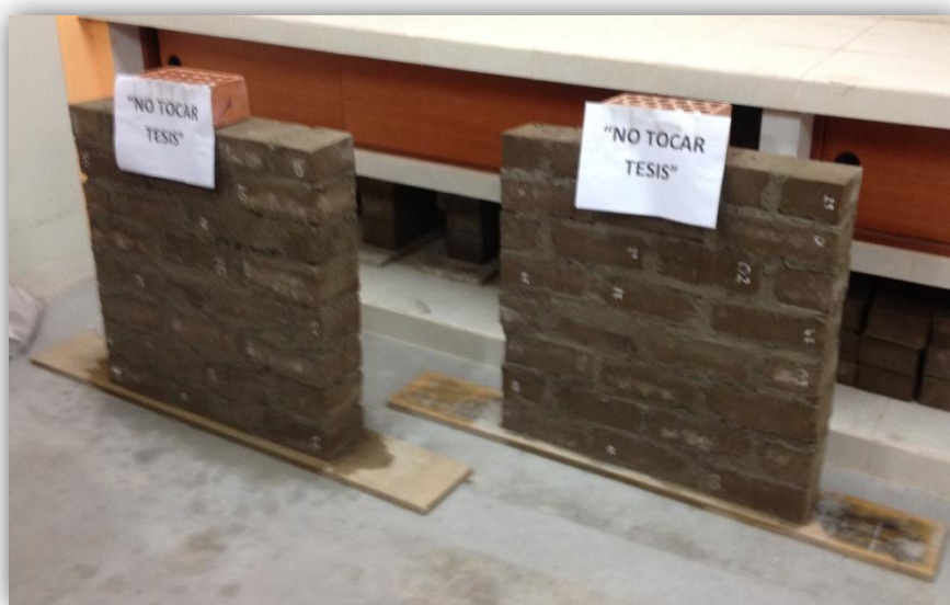
Figura N° 28: Muretes contruidos de 72x72cm
