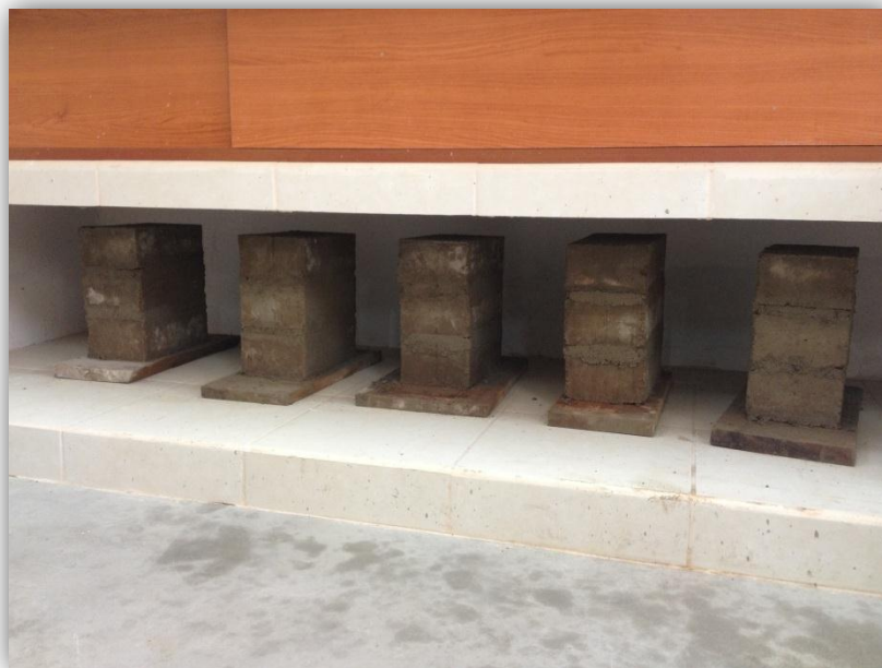
Figura N° 26: Pilas construidas de tres hiladas
