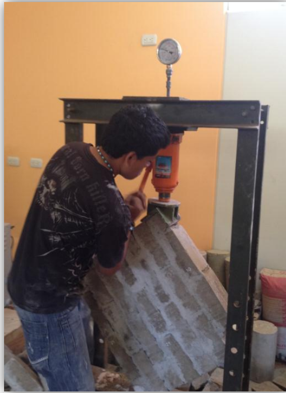
Figura Nº 41: Aplicación de carga sobre murete
