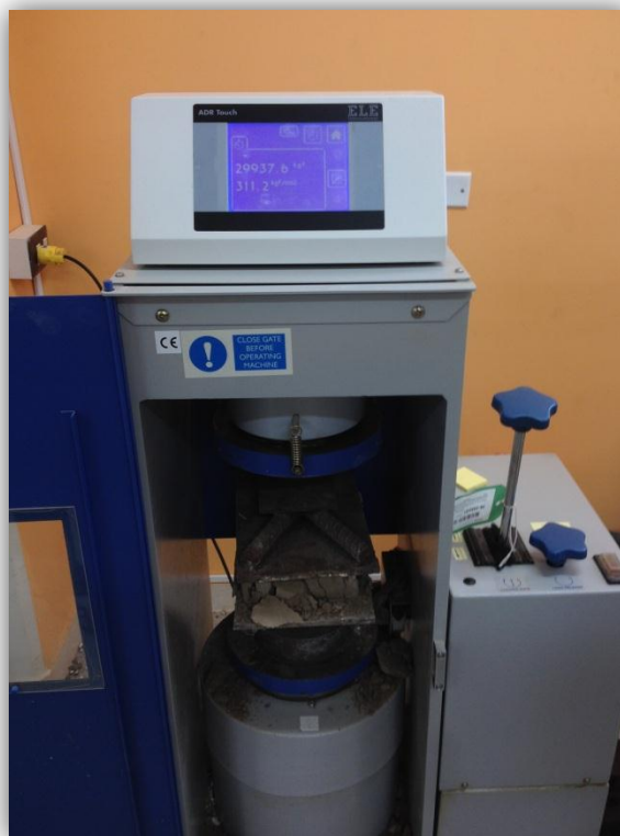
Figura N° 33: Unidad de albañilería ubicada en la máquina de rotura
