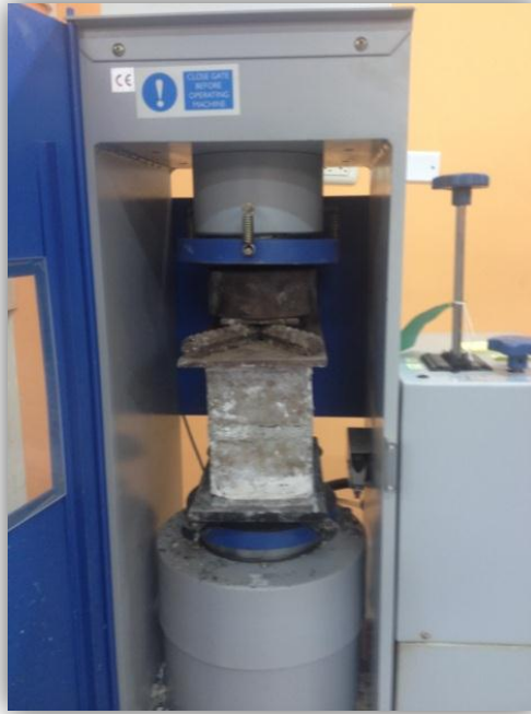
Figura N° 16: Pilas de albañilería sujeta compresión axial
