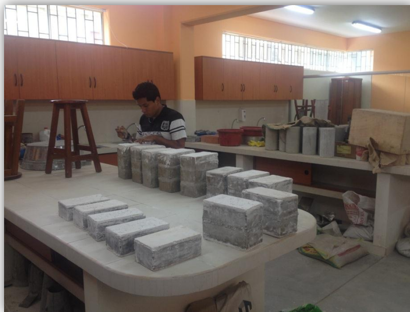
Figura N° 35: Pilas de albañilería de 2 y 3 hileras
