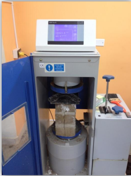
Figura N° 38: Ensayo y forma de falla para pilas de 3 hileras
