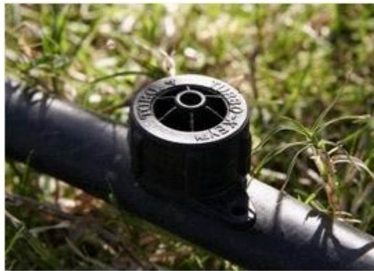
Figura N° 2.2: Gotero de riego
