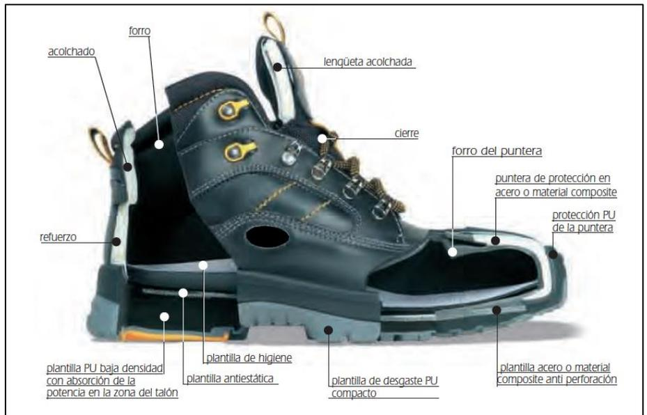
*Figura 3: Calzado de Seguridad como Equipo de Protección Individual*
