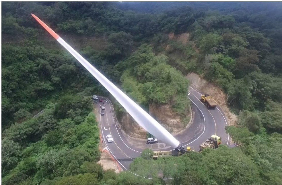
Figura 3.4 - Transporte especial de Palas.
