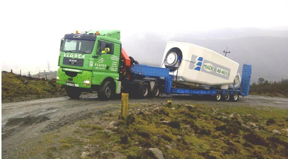
Figura 3.5 - Transporte especial de Nacelle.
