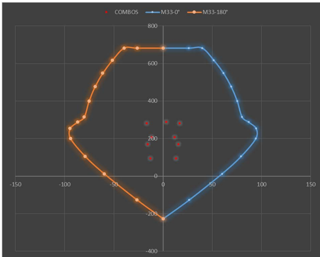
Figura N° 207: Resultados del sismo YY para la curva de los ángulos 0° y 180° Elaboración propia
