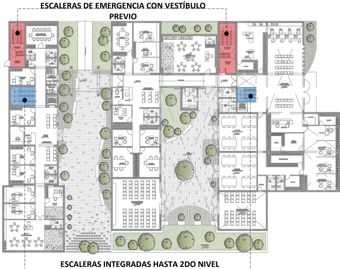
IMAGEN N°131: Esquema de Señalización de escalera de Evacuación.
