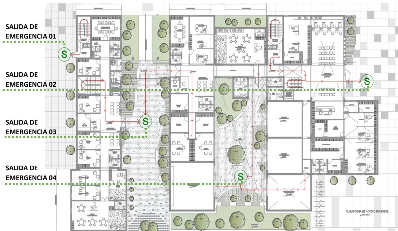
IMAGEN N°132: Esquema de Señalización de Salidas de Emergencia
