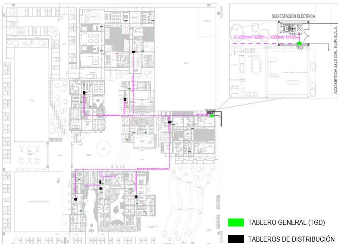
IMAGEN N°124: Plano Planteamiento General de Instalaciones Eléctricas
