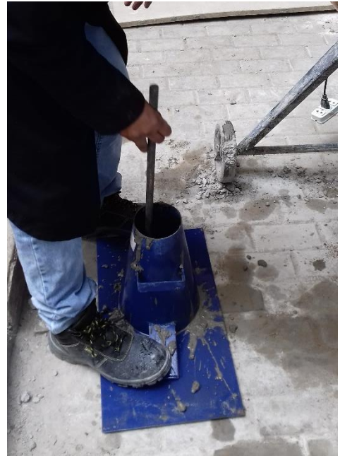
Imagen 13. Ensayos de concreto en estado fresco: Temperatura, Slump y preparación del concreto a diferentes diseños
