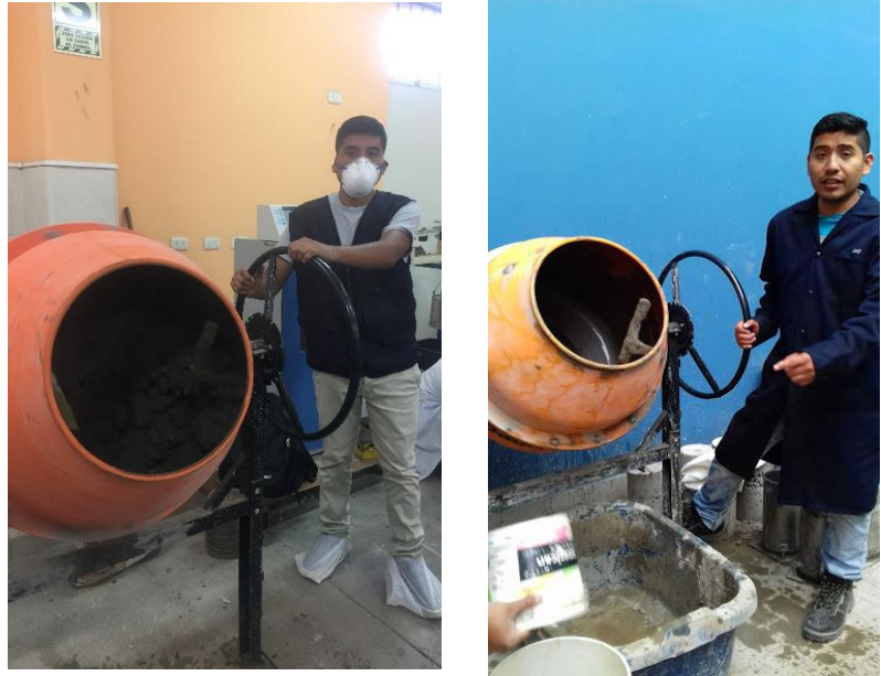
Imagen 3. Elaboración de las diferentes mezclas de concreto
