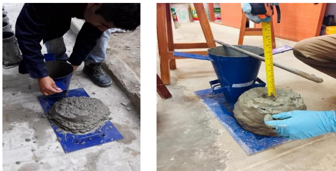
Imagen 4. Medición y Verificación del Slump
