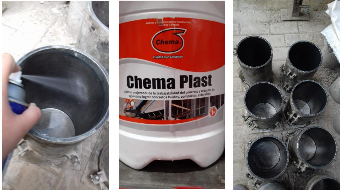
Imagen 11. Preparación de las probetas con un lubricante de la marca DW, para que el concreto al ser desarmado, sea mucha más fácil y no permite su adherencia, así como el pesado del aditivo.
