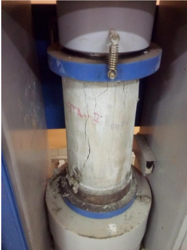
Imagen 14. Ensayo de compresión de testigos de concreto y Módulo de Elasticidad Estático Experimental en el Laboratorio de Ensayo de Materiales.
