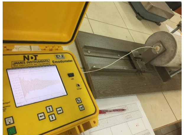
Imagen 15. Ensayo de Módulo de Elasticidad Dinámico con el equipo de resonancia V-E Endumer 400 en el Laboratorio de Ensayo de Materiales de la Universidad Privada Antenor ORREGO
