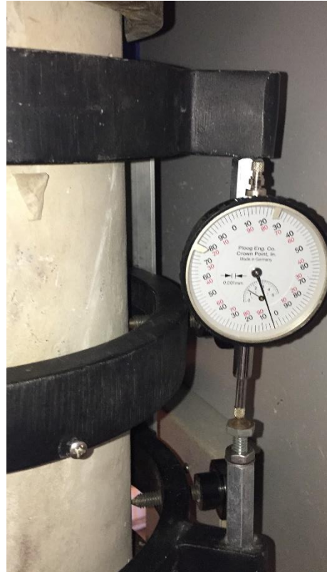
Imagen 14. Ensayo de compresión de testigos de concreto y Módulo de Elasticidad Estático Experimental en el Laboratorio de Ensayo de Materiales.
