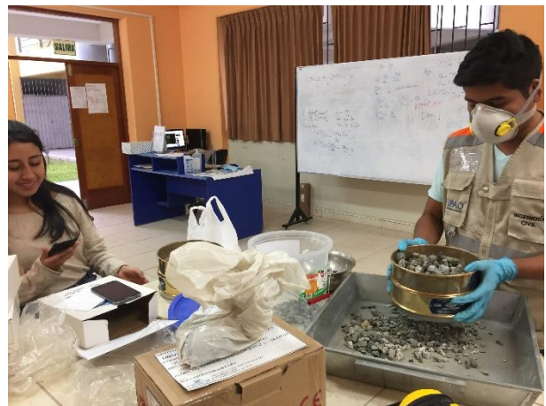
Imagen 10. Ensayos de Propiedades Físicas y Mecánicas de los agregados (Piedra y Arena) en Los Laboratorios de Ing. Civil de la Universidad Privada Antenor Orrego.
