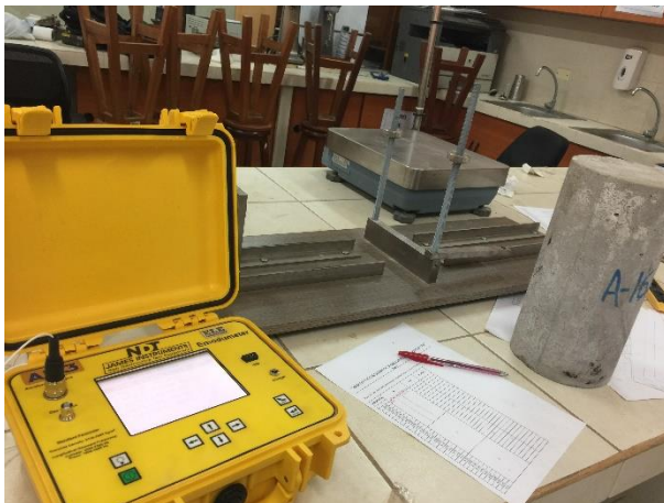
Imagen 15. Ensayo de Módulo de Elasticidad Dinámico con el equipo de resonancia V-E Endumer 400 en el Laboratorio de Ensayo de Materiales de la Universidad Privada Antenor ORREGO
