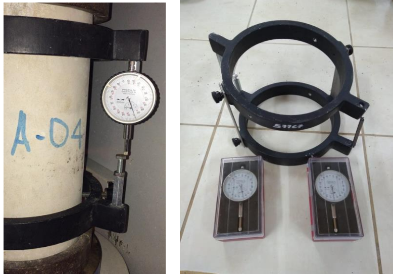
Imagen 8. Análisis del Módulo Estático experimental con: sistema de análisis + diales de deformación.
