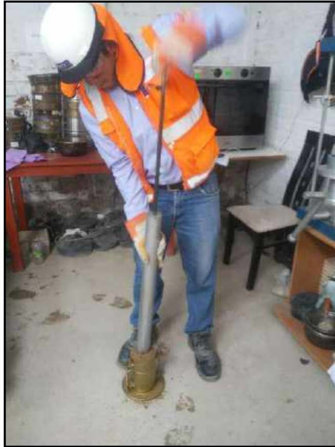
Fotografía N° 19: Ensayo de Proctor para Material de Préstamo
