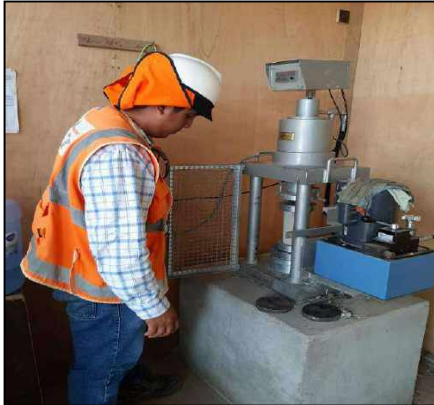
Fotografía N° 29: Rotura de Probeta en Prensa de Concreto
