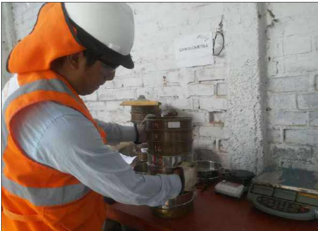
Fotografía N° 04: Ensayo de Granulometría del Hormigón
