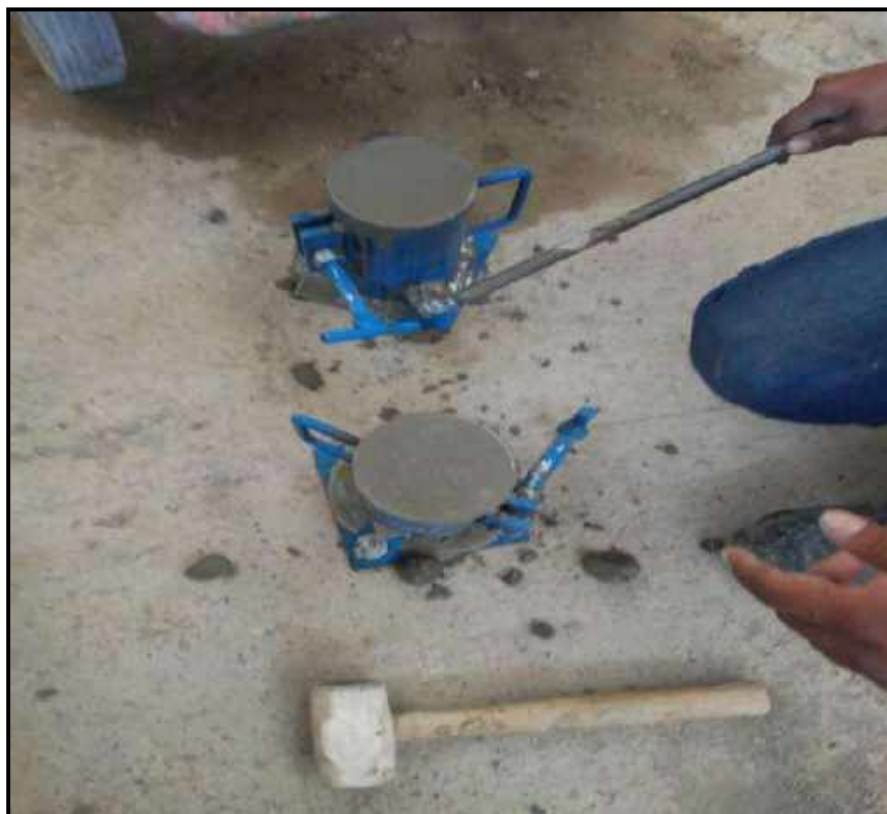
Fotografía N° 28: Moldeo de Probetas de Relleno Fluido
