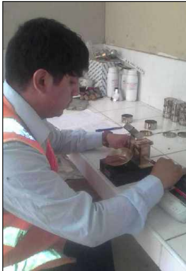
Fotografía N° 16: Ensayo de Límite Líquido mediante la Copa de Casagrande
