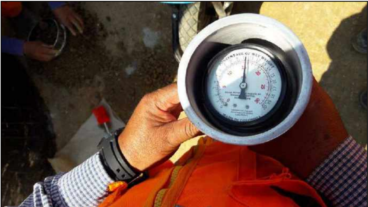
Fotografía N° 22: Obtención de contenido de humedad de suelo mediante medidor de humedad tipo Speedy
