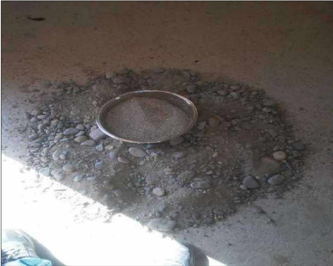
Fotografía N° 03: Muestra y Porción para ensayo de granulometría del Hormigón
