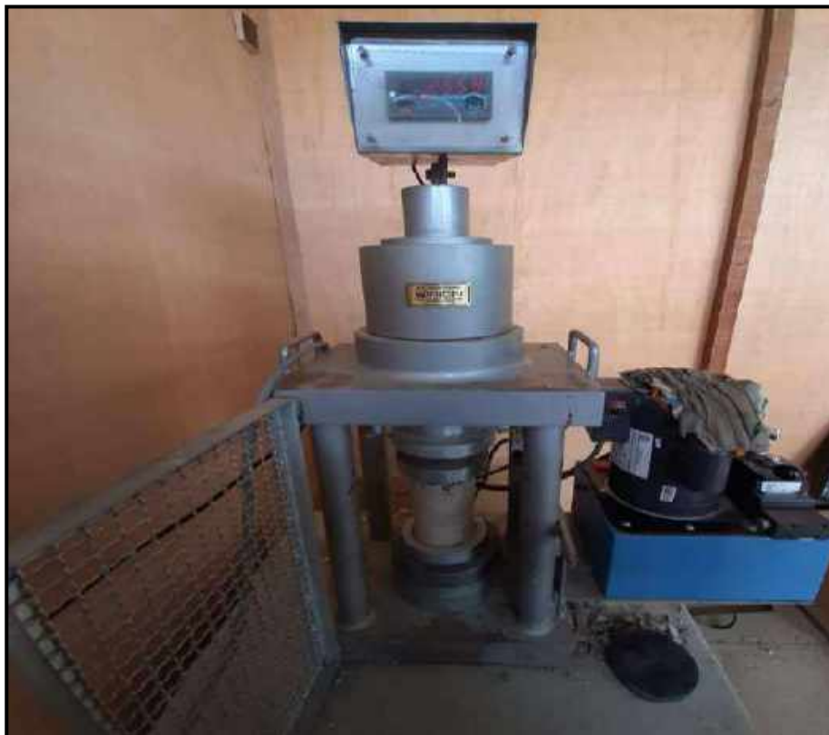
Fotografía N° 30: Rotura de Probeta a los 7 días en Prensa de Concreto
