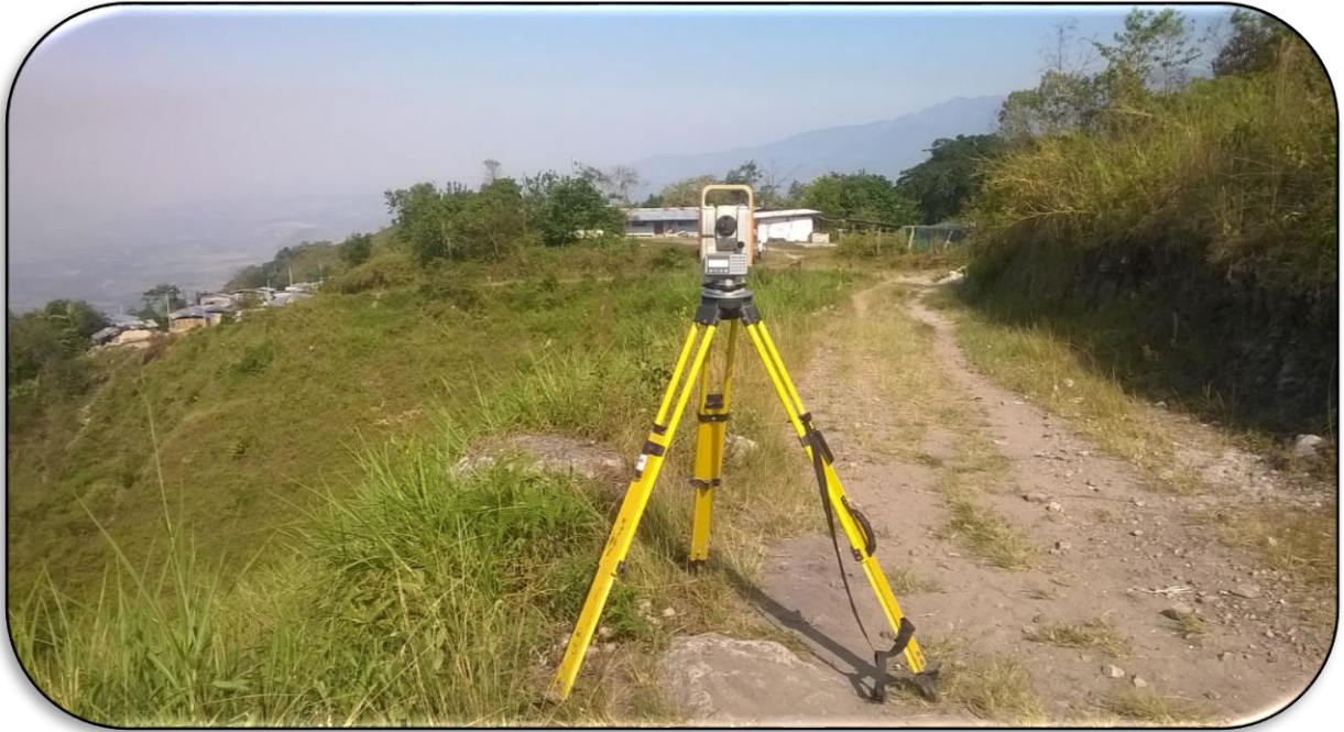
Foto 03. Vista de la zona de trazo topográfico de la línea de aducción.
