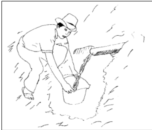
Figura 6. Aforo del agua por el método volumétrico.
