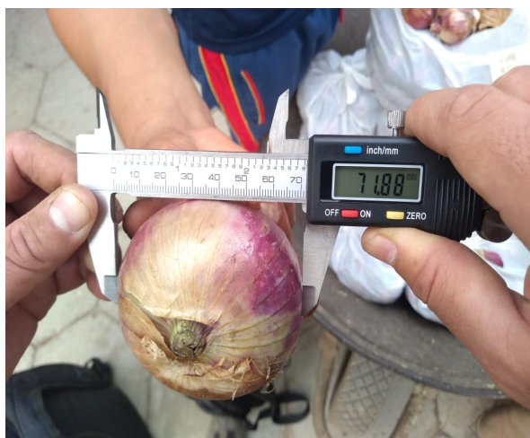
Figura 3. Medición de diámetro de bulbo. Original del autor.
