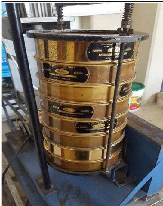
**Imagen 7.** Tamizado de las muestras. Ensayo de granulometría.
