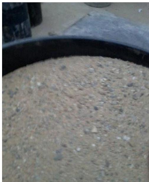
**Imagen 2.** Agregado fino para concreto
