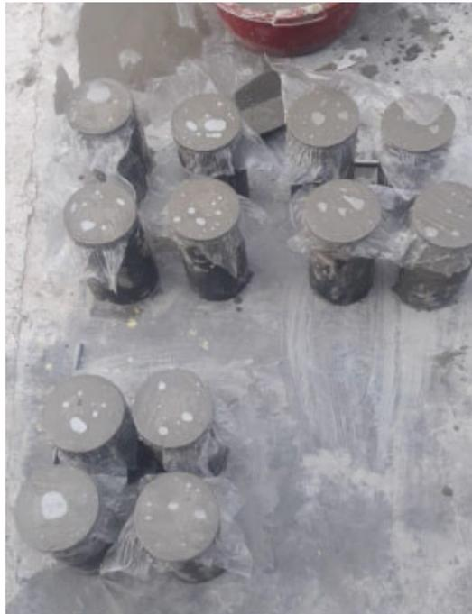
**Imagen 18.** Probetas de concreto llenadas para inicio de fraguado.
