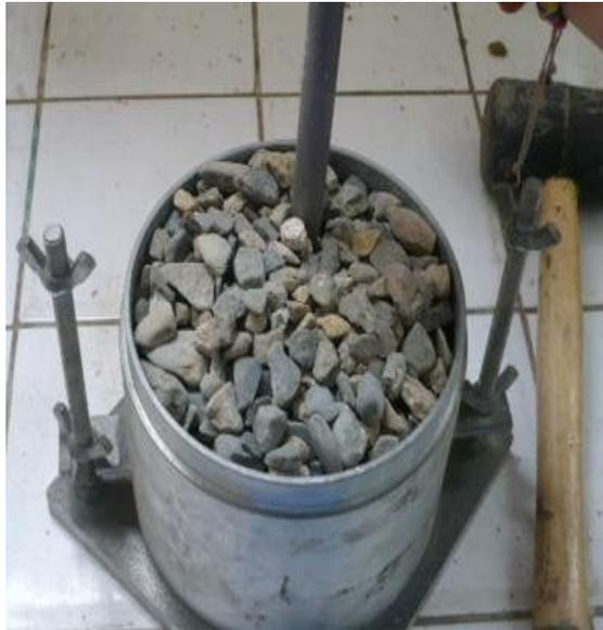
**Imagen 9.** Ensayo de peso unitario suelo y compacto del agregado grueso
