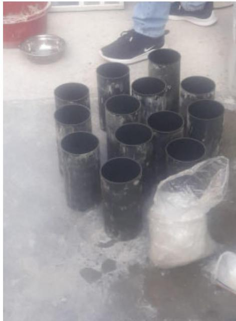
**Imagen 16.** Moldes para probetas de concreto.
