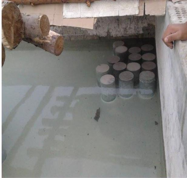
**Figura 19.** Curado de probetas de concreto
