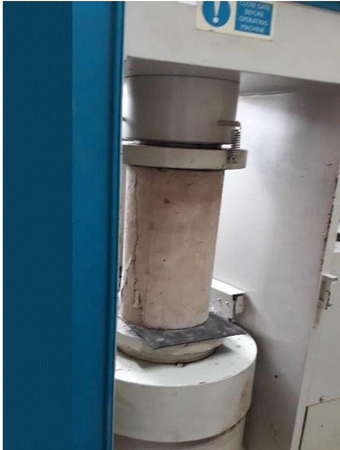
**Figura 21.** Ensayo de resistencia a la compresión de probetas de concreto.
