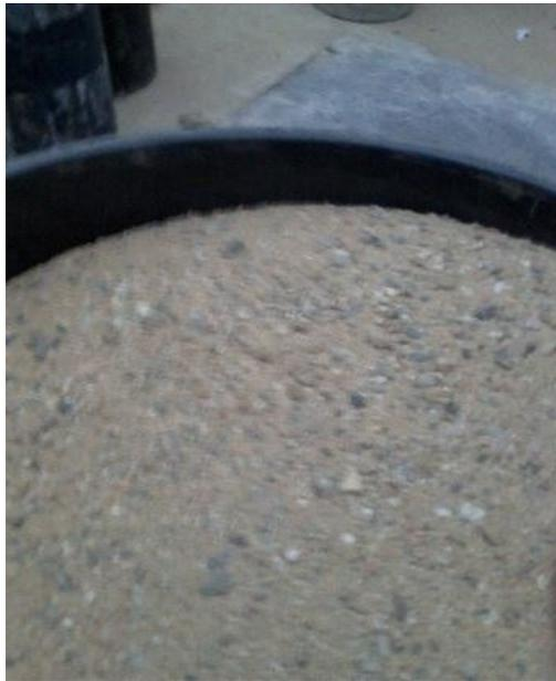
**Imagen 2.** Agregado fino para concreto
