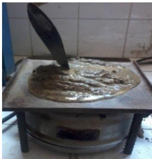
**Imagen 11.** Ensayo de absorción y porosidad de agregado fino
