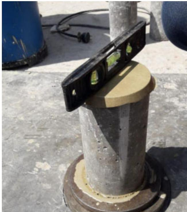
**Figura 20.** Capeado y nivelado de caras de probetas de concreto.
