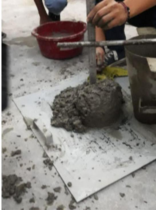
**Imagen 15.** Prueba de slum para comprobar al del diseño de mezcla
