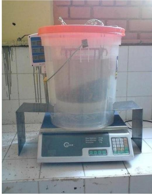
**Imagen 13.** Ensayo de absorción y peso específico de agregado grueso
