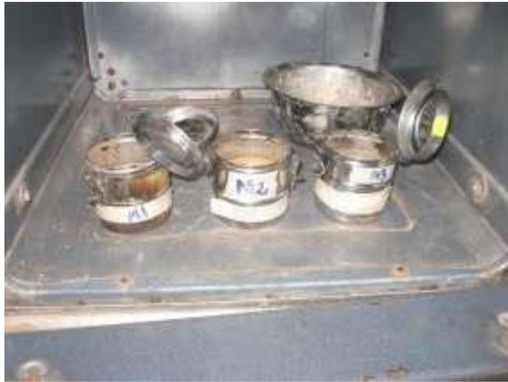
**Imagen 4.** Secado de muestras para ensayo de humedad.
