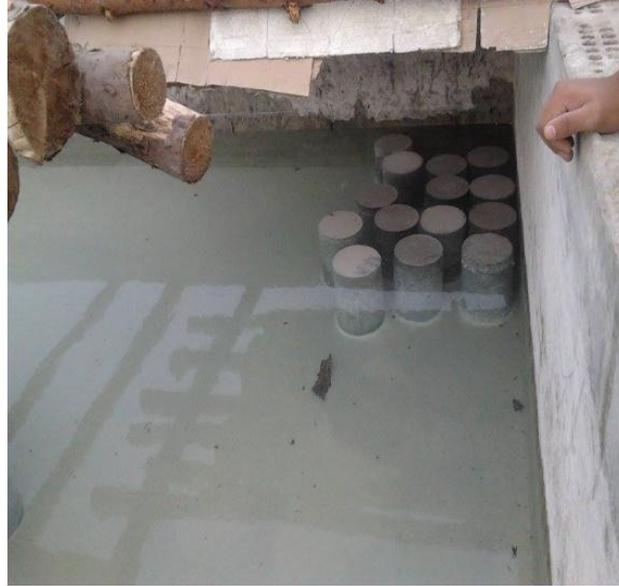
**Figura 19.** Curado de probetas de concreto
