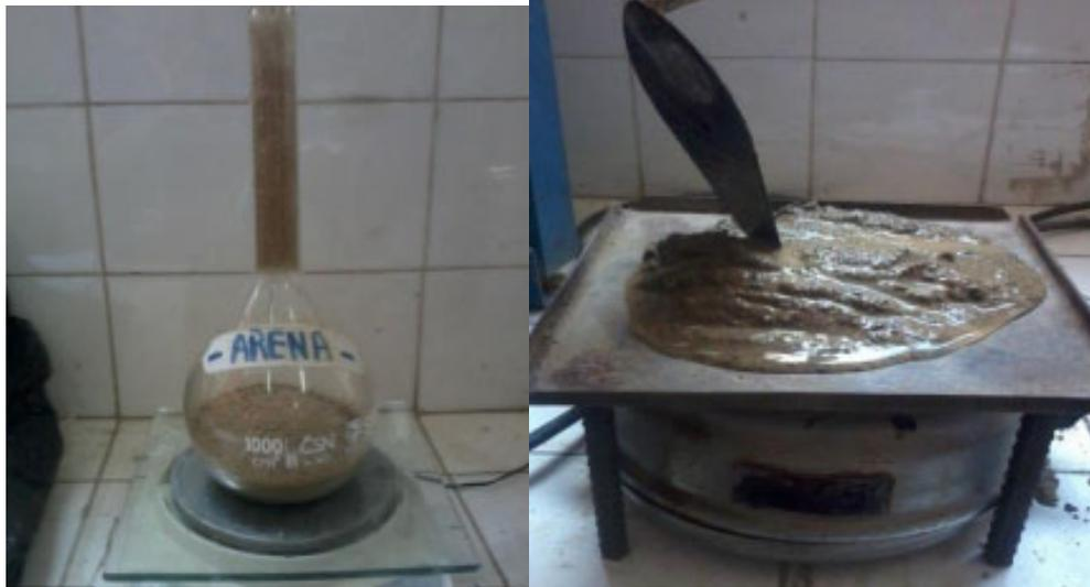
**Imagen 11.** Ensayo de absorción y porosidad de agregado fino
