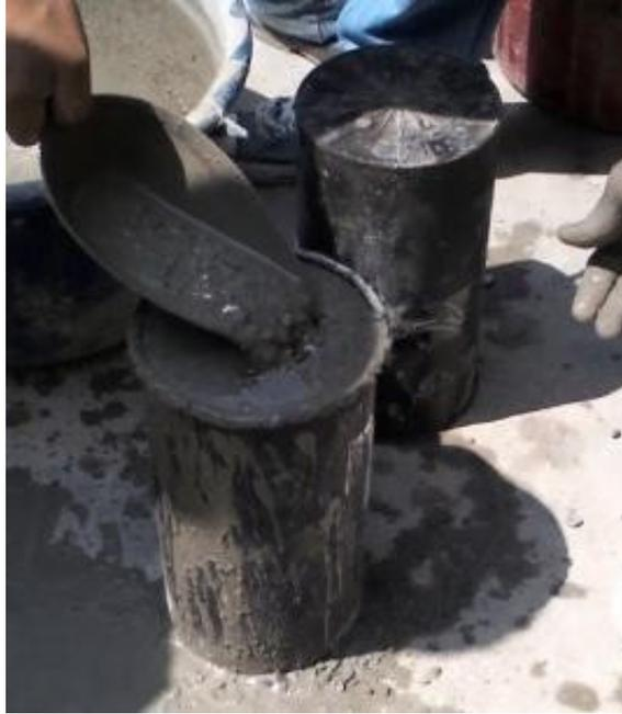
**Imagen 17.** Llenado de probetas de concreto
