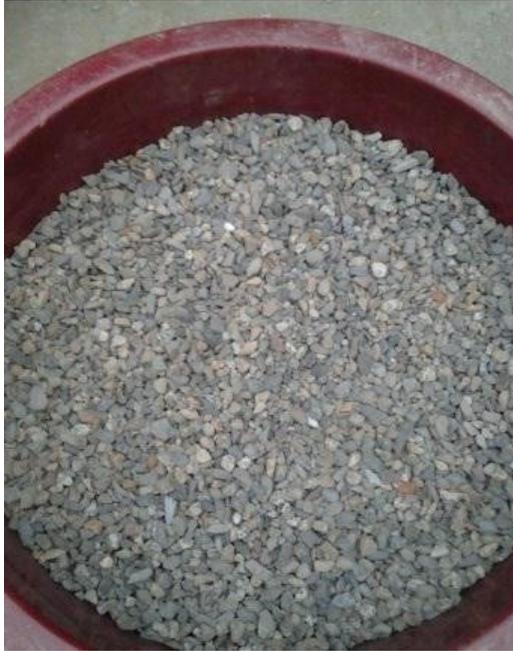
**Imagen 1.** Agregado grueso para concreto
