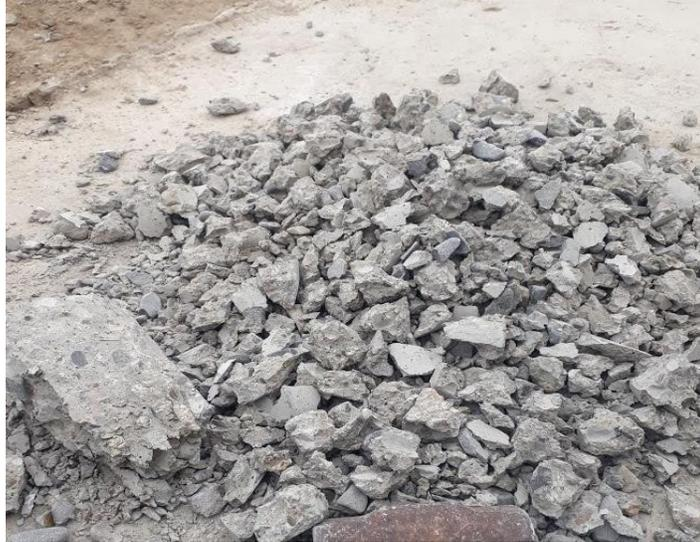
**Imagen 3.** Preparación del agregado reciclado de escombros para concreto
