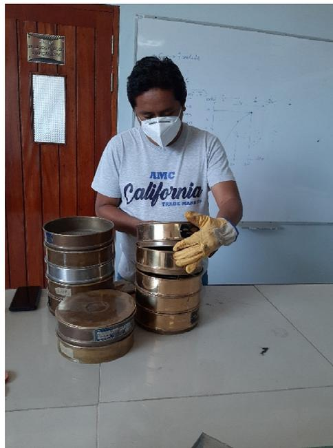
**Imagen 5.** Preparación y limpieza de mallas granulométricas
