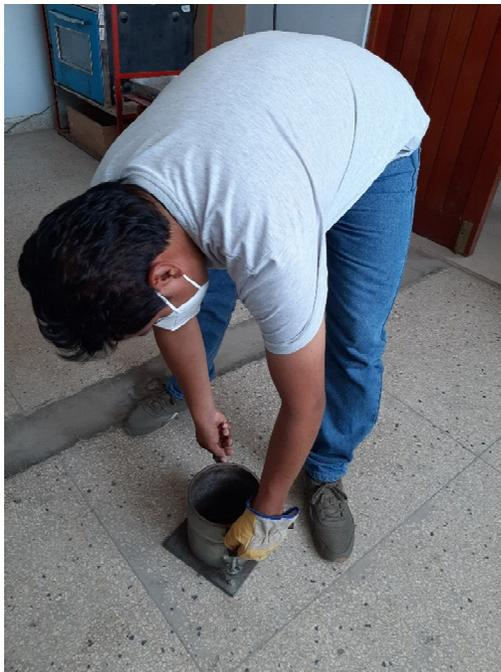
**Imagen 8.** Preparación del molde para ensayo de peso unitario de agregados.
