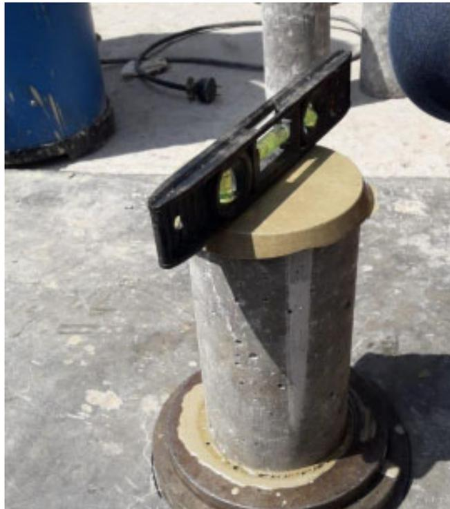
**Figura 20.** Capeado y nivelado de caras de probetas de concreto.
