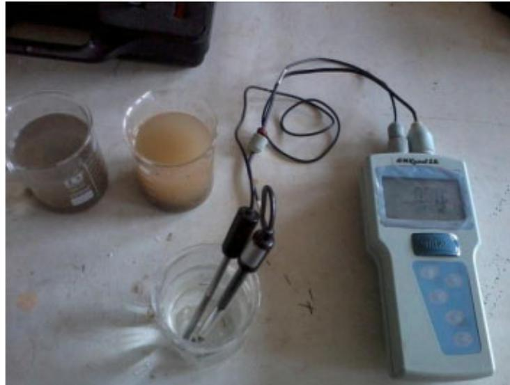
**Imagen 12.** Ensayo de ph, conductividad eléctrica y TDS.
