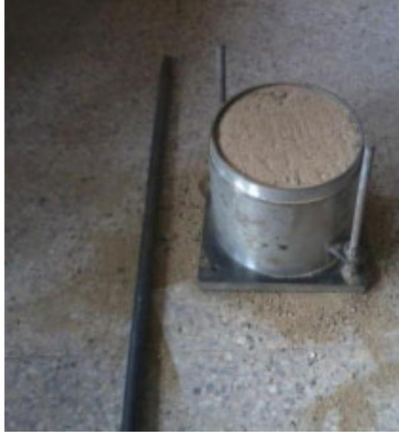
**Imagen 10.** Ensayo de peso unitario suelo y compacto del agregado fino
