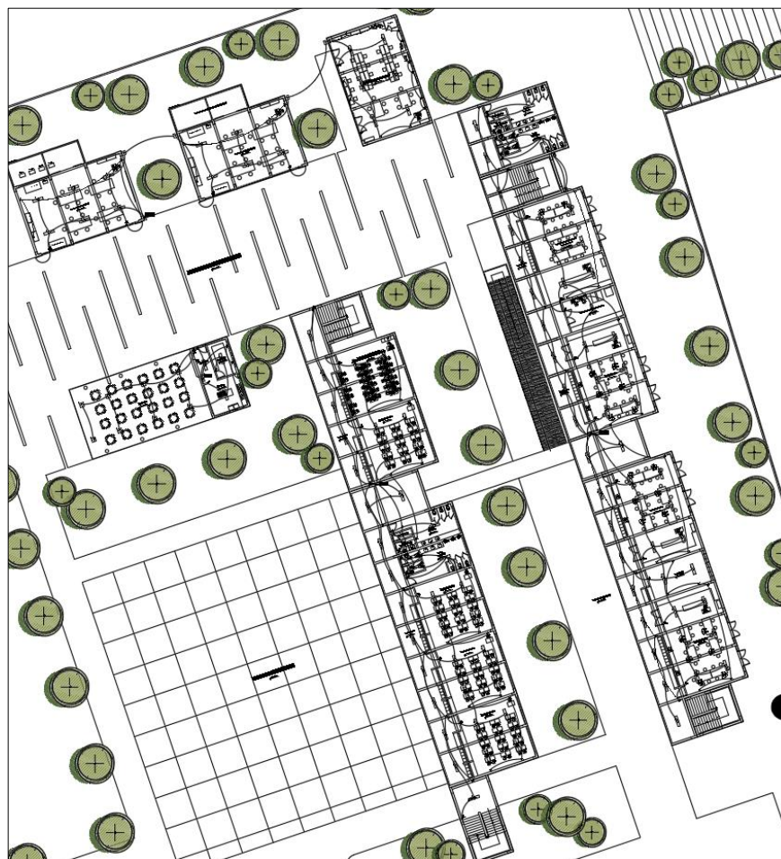
Imagen 81: Esquema de centros de luz y tomacorrientes 1° piso Fuente: Elaboración propia
