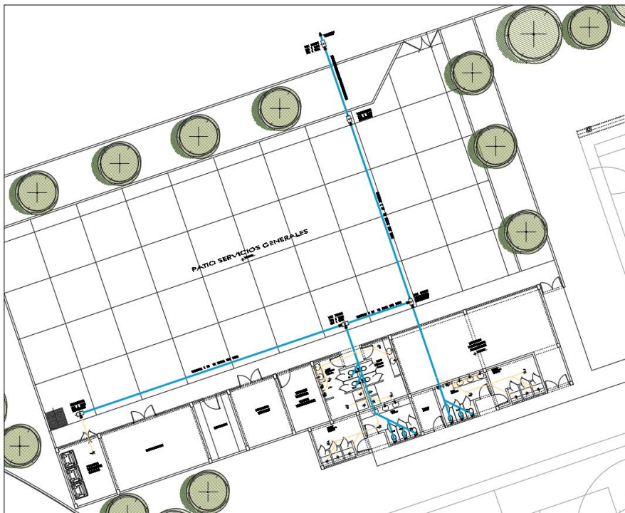
Imagen 78: Esquema red de desagüe Ramal 4 Fuente: Elaboración propia
