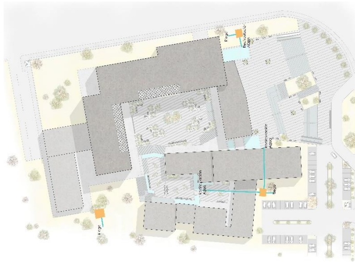
Imagen 31: Distribución de agua tratada
