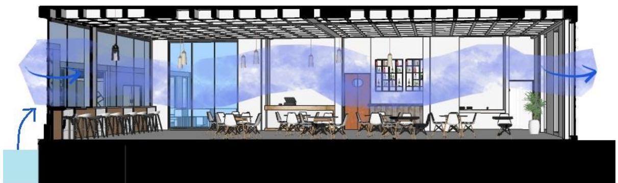
Imagen 28: Ventilación por Sist. Evapo. de Cafetería
