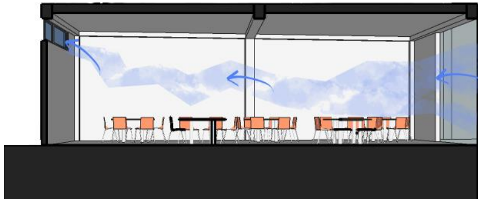
Imagen 26: Ventilación Cruzada en Bloque de Talleres
