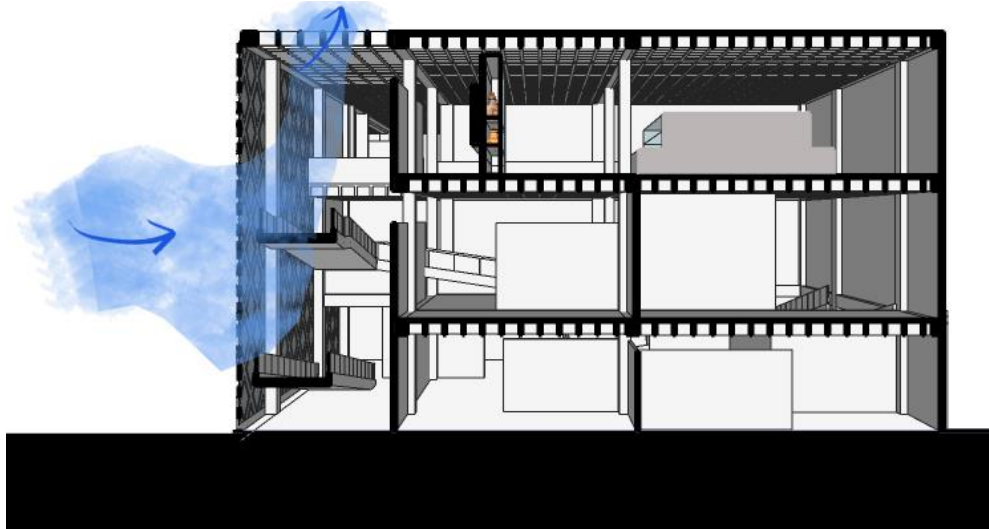
Imagen 27: Ventilación mediante Cubierta de Bloque Exp. Permanente
