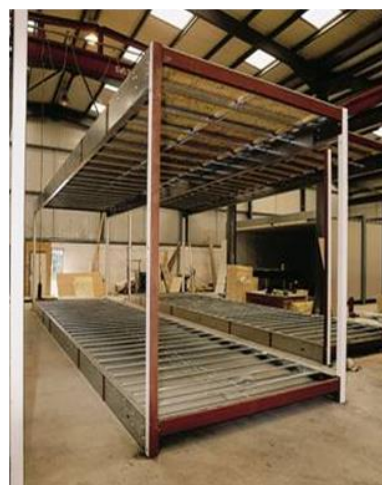
Imagen 36: BASTIDOR DE ACERO PRIMARIO UTILIZADO EN UN MÓDULO DE LADOS COMPLETAMENTE ABIERTOS
