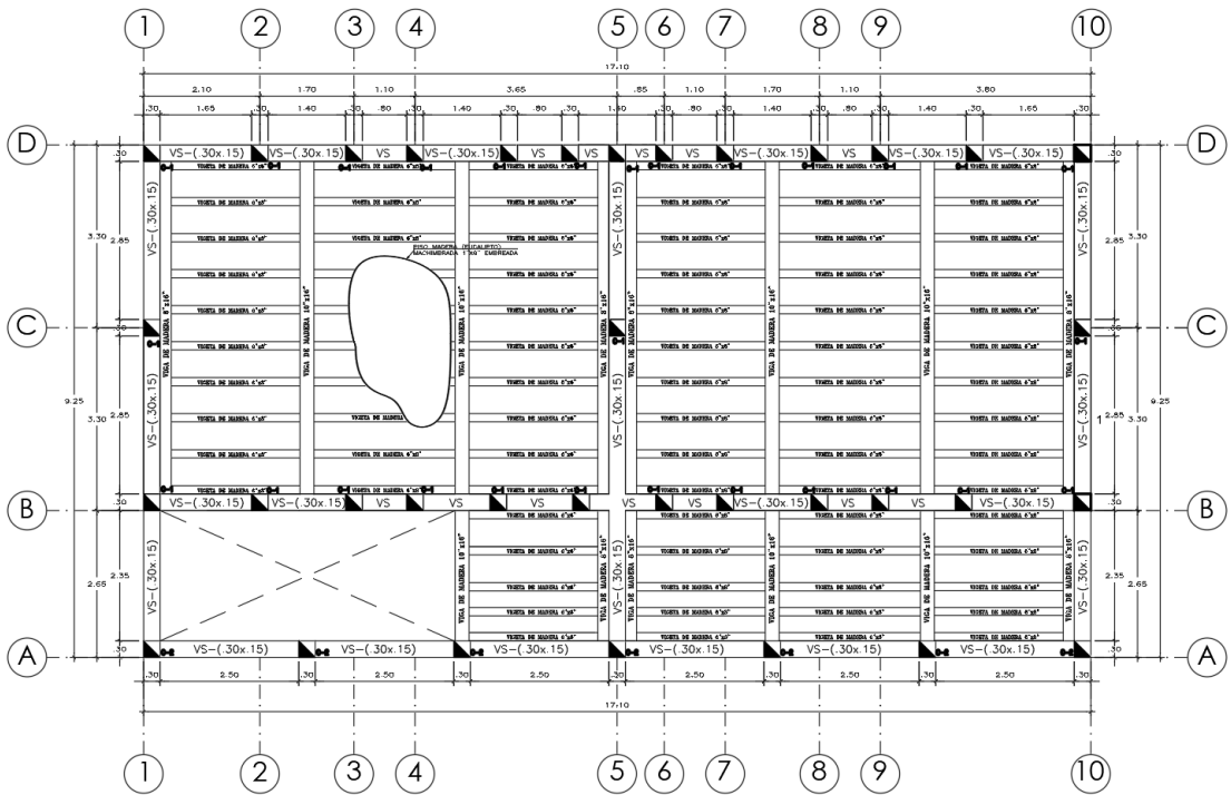
PLANTA DE ALIGERADO 1 er Nivel, BLOQUE 14 ESCALA: 1/80
