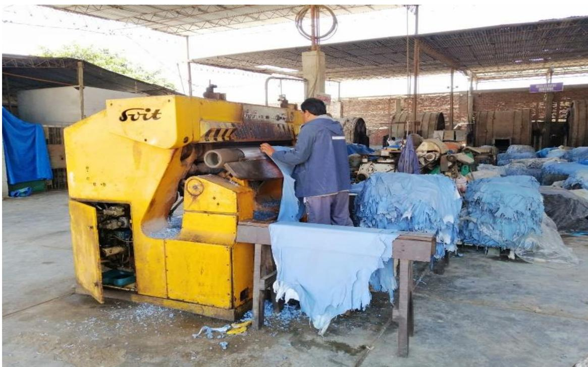
*Nota.* Esta figura muestra la máquina rebajadora el cual me permitirá alcanzar el espesor indicado del cuero y a gusto del cliente.
