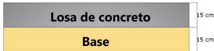
Figura 17: Espesores del Pavimento Rígido
