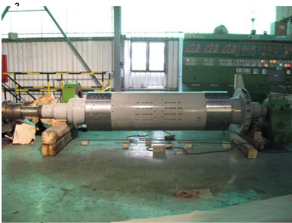
Fig 2.12 Rotor de polos lisos de Turbogenerador de Trupal S.A
