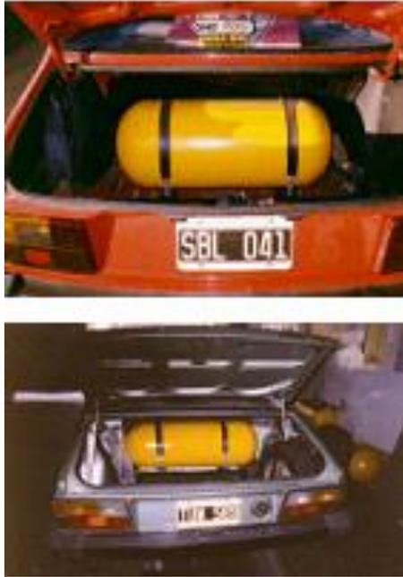
Figura 4: Tanque de almacenamiento de GNC.
